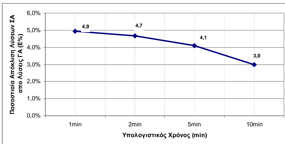
Σχήμα 5.10 Μέση ποσοστιαία απόκλιση λύσεων ΣΑ από τις λύσεις του ΓΑ (για όλες τις τιμές T_{\max} ) -με διαφορετικούς υπολογιστικούς χρόνους για τα προβλήματα 3 και 5 με 2, 3 και 4 ενεργά οχήματα
