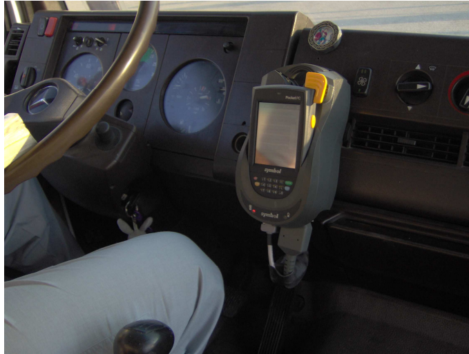
Σχήμα 4.16 Τηλεματική μονάδα οχήματος
