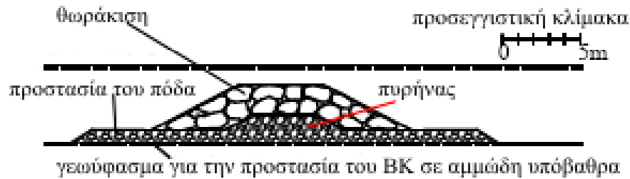
Σχήμα 1.5: Σχηματική απεικόνιση της τομής ενός ΒΚ με τα διάφορα στρώματα από τα οποία αποτελείται (DELOS, 2004)
