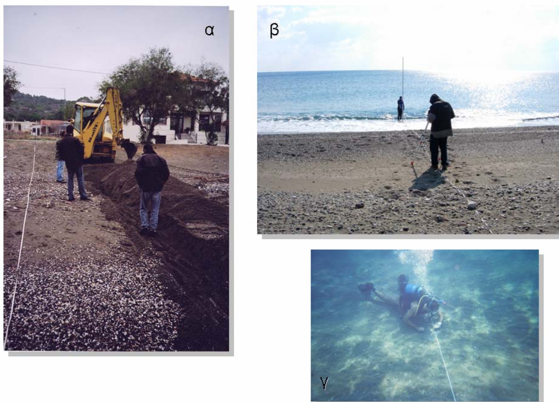
Εικόνα 5-1 Μέθοδοι που χρησιμοποιήθηκαν στις μορφολογικές αποτυπώσεις. (α) Εκσκαφή της παραλίας για την τοπογραφική αποτύπωση της άνω επιφάνειας του παραλιακού ψαμμίτη· (β) αποτύπωση με σταδία και χωροβάτη του άνω (χερσαίου και αβαθούς υποθαλάσσιου) τμήματος του παραλιακού προφίλ· και (γ) αποτύπωση του υποθαλάσσιου τμήματος του παραλιακού προφίλ από αυτοδύτη και αισθητήρα πίεσης.
