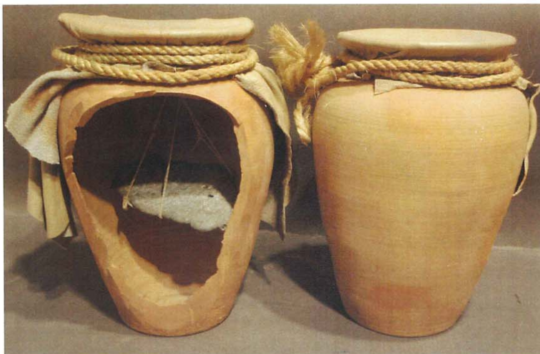
Εικ.5.16: Η πειραματική ανακατασκευή της συσκευής από την περιγραφή του Θεοφράστου για την παραγωγή του ψιμυθίου (σχεδιασμός κατασκευή του γράφοντος).
