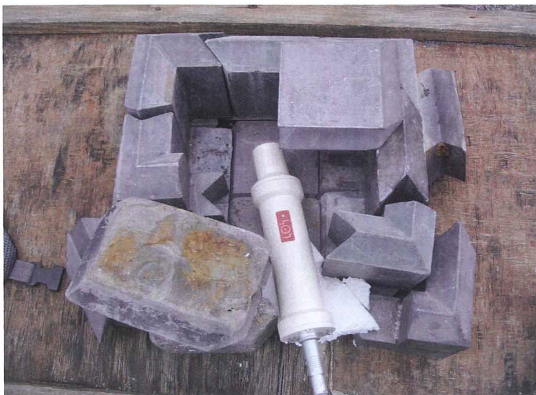
Εικ.7.78: Ο τρόπος της τοποθέτησης του αισθητήρα του σπινθηρομέτρου στον κλωβό από μόλυβδο.
