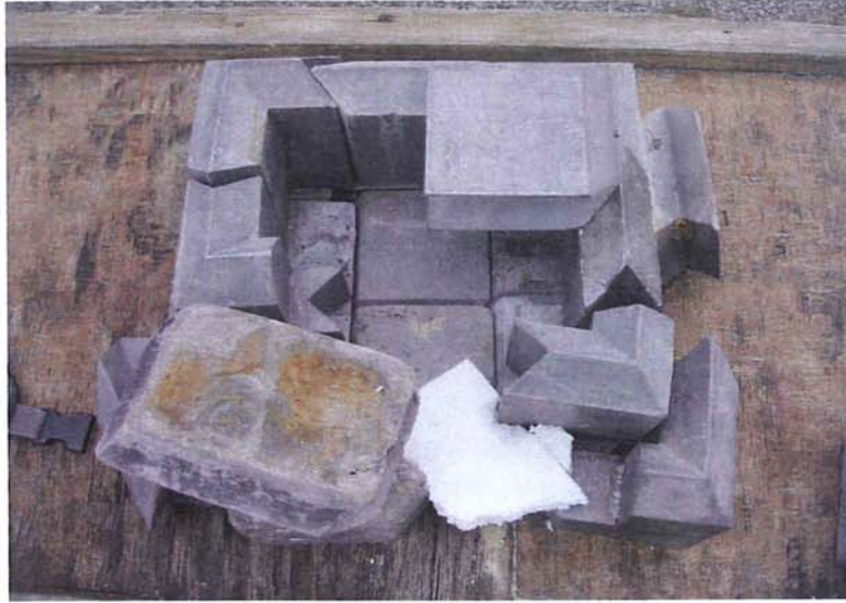
Εικ.7.76: Η διάταξη της θωράκισης από μόλυβδο που κατασκευάσαμε προκειμένου να κάνουμε τις μετρήσεις με το σπινθηρόμετρο Geiger.
