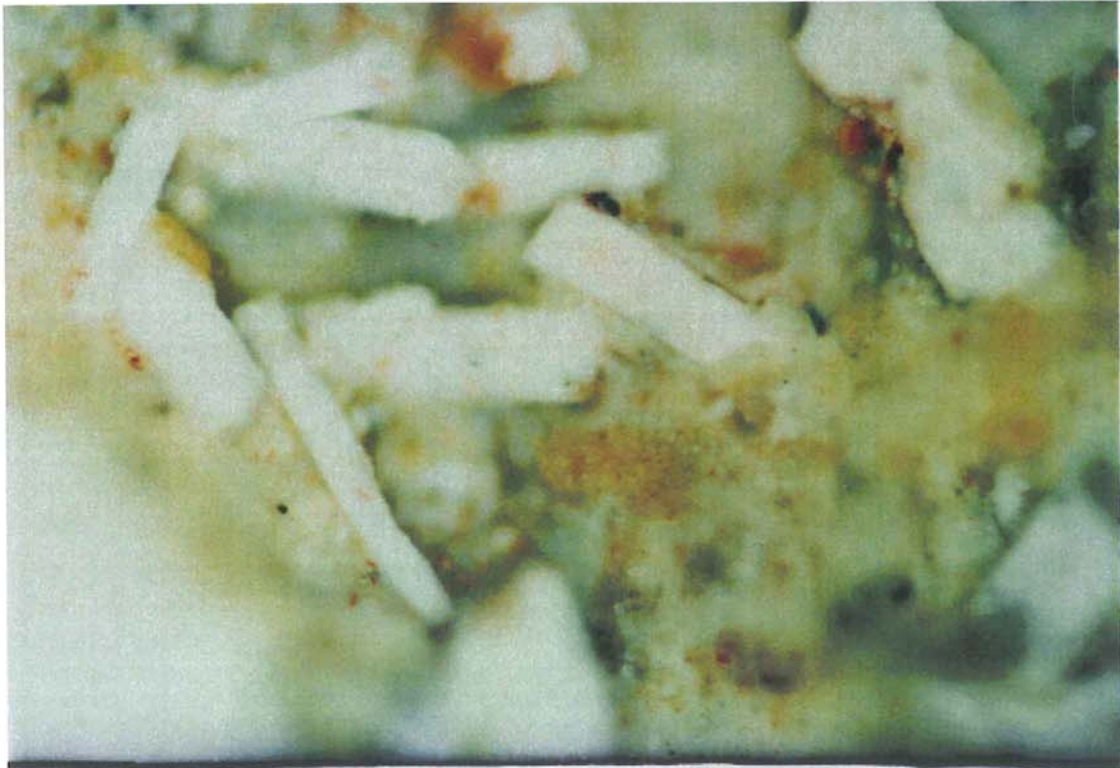
Εικ.5.18α: (30X) των κρυστάλλων του κερουσίτη στο δείγμα PSI-1.
