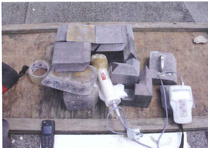
Εικ. 7.79: Η μέτρηση του δείγματος μέσα στον μολύβδινο κλωβό.
