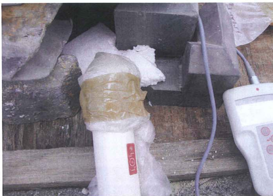
Εικ. 7.80: Ο τρόπος προσαρμογής του προς ανάλυση δείγματος στον αισθητήρα του σπινθηρομέτρου.
