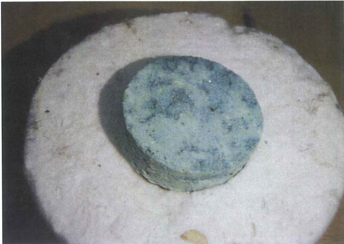
Εικ. 8.7: Το τελικό προϊόν όπως προέκυψε μετά από ψήσιμο 20 ωρών στον ηλεκτρικό φούρνο. Το δείγμα έχει τον κωδικό EGY-3.
