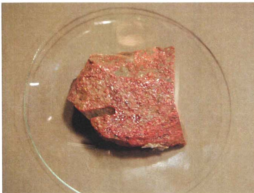
Εικ. 7.1: Δείγμα ορυκτού κινναβαρίτη από τα μεταλλεία του Αλμάντεν της Ισπανίας με κωδικό CIN-1.
