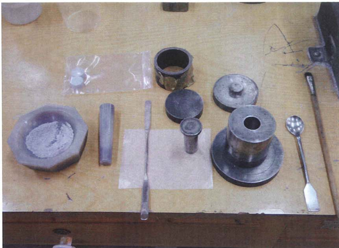
Εικ. 8.4: Το γουδί από αχάτη που χρησιμοποιήθηκε στο πείραμα και η χαλύβδινη μήτρα όπου διαμορφώθηκαν οι παστίλιες για την παραγωγή του αιγυπτιακού μπλε.
