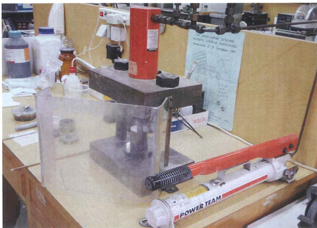
Εικ. 8.5: Η πρέσα που χρησιμοποιήσαμε για την προετοιμασία των δειγμάτων προκειμένου να διαμορφωθούν σε παστίλιες.
