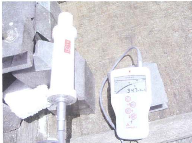
Εικ. 7.77: Το σπινθηρόμετρο Geiger το οποίο χρησιμοποιήσαμε για τις μετρήσεις των δειγμάτων.
