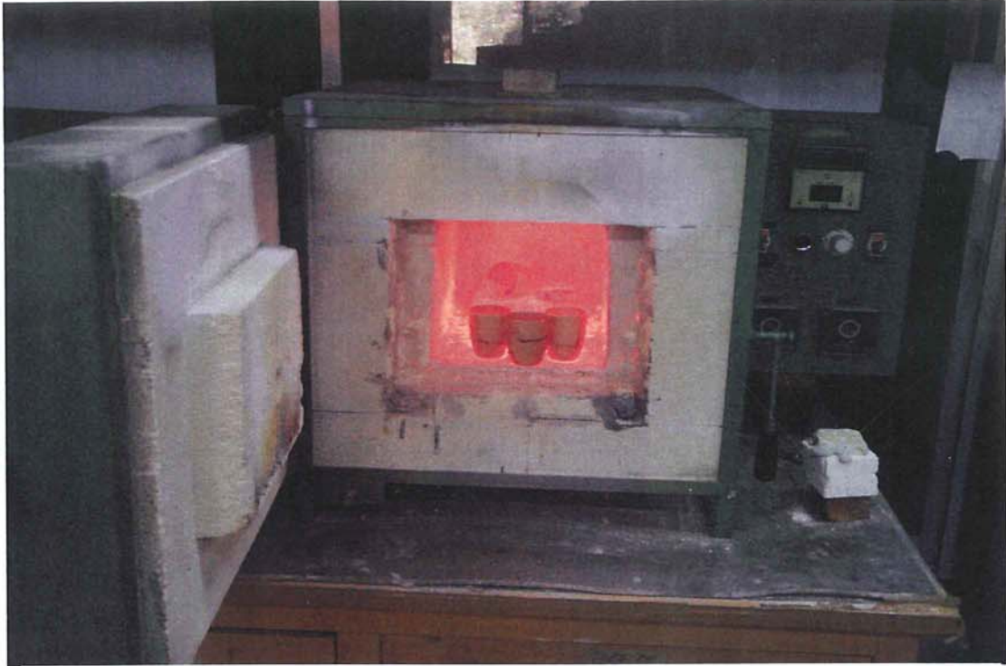
Εικ. 8.6: Ο ηλεκτρικός φούρνος στο εργαστήριο Προηγμένων Κεραμικών του Ινστιτούτου Επιστήμης Υλικών του ΕΚΕΦΕ Δημόκριτος. Κατά την διάρκεια του πειράματος στα χωνευτήρια έχουν τοποθετηθεί τα δοκίμια με την προαναφερθείσα αναλογία υλικών για την παραγωγή του αιγυπτιακού μπλε..
