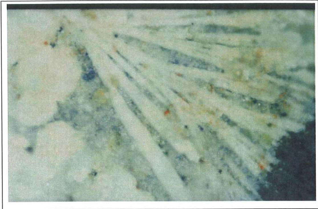
Εικ. 5.17: Φωτομικρογραφία (20X) του λευκού επανθίσματος του δείγματος PSI-1 που εμφανίστηκε στην πλάκα του μολύβδου κατά την δέκατη μέρα του πειράματος.
