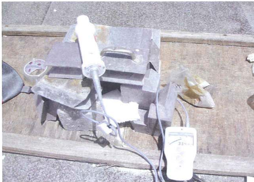
Εικ. 7.82: Η ένδειξη του σπινθηρομέτρου στο περιβάλλον έξω του μολύβδινου κλωβού.
