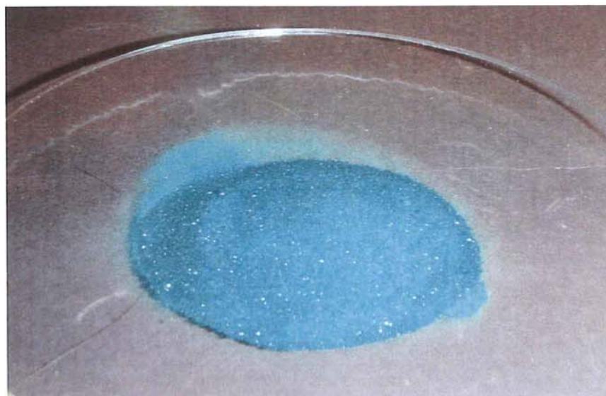
Εικ.9.34: Το δείγμα όπως προέκυψε μετά από την απόξεση του από το έλασμα του χαλκού με κωδικό IOS-1.
