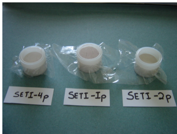
Εικ. 2.2: Δειγματολήπτες με σκόνη για μέτρηση με τη μέθοδο ακτίνων-Χ φθορισμού με τη συσκευή TN Spectrace 9000.
