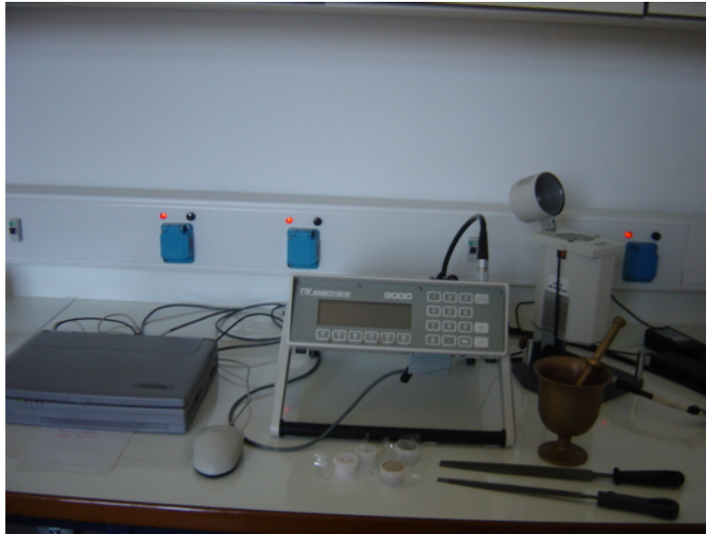
Εικ. 2.1: Ο ανιχνευτής TN Spectrace 9000 ακτίνων-Χ φθορισμού του εργαστηρίου Αρχαιομετρίας, του Πανεπιστημίου Αιγαίου στη Ρόδο.
