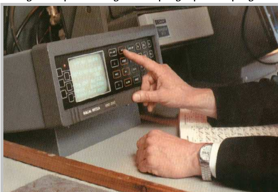
Σχήμα 4.8: Συνδυασμένος δέκτης για την παροχή στίγματος από τα NAVSAT TRANSIT, GPS και υπερβολικής ναυτιλίας (LORAN-C και DECCA).
