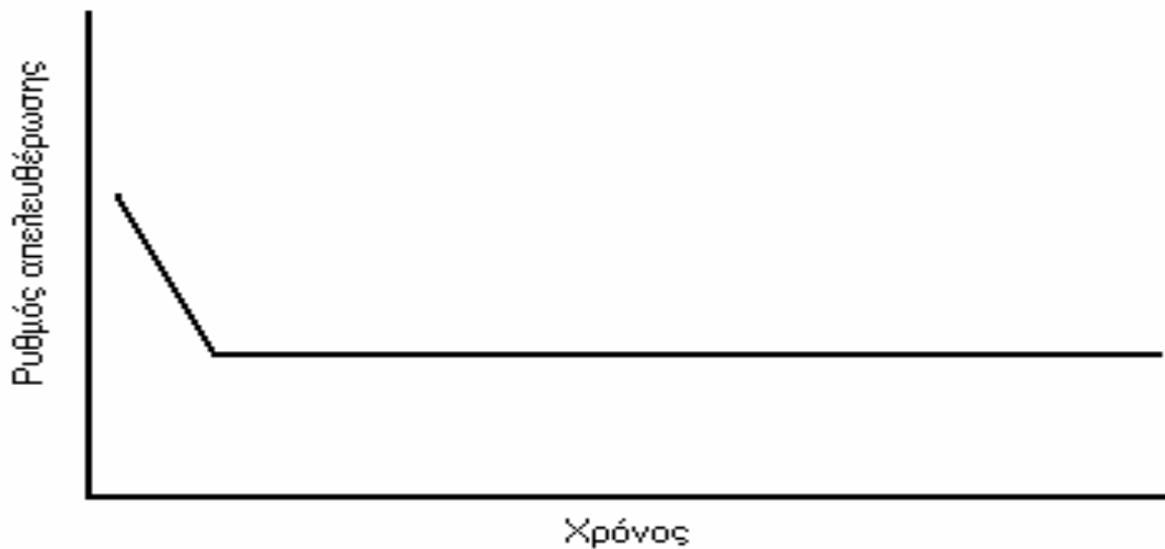
Σχήμα 1.3 Ρυθμός απελευθέρωσης τοξικής ουσίας σε συμπολυμερές αυτολειαινόμενο υφαλόχρωμα.
