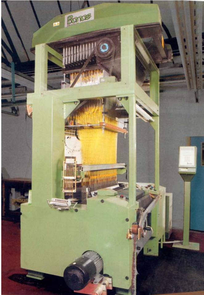
φωτ.1.30 σύγχρονος, ηλεκτρονικά ελεγχόμενος αργαλειός ζακάρ της εταιρείας Eltex, με κεφαλή ζακάρ της εταιρείας Bonas (φωτ. από κατάλογο της Eltex U.K. Limited)
