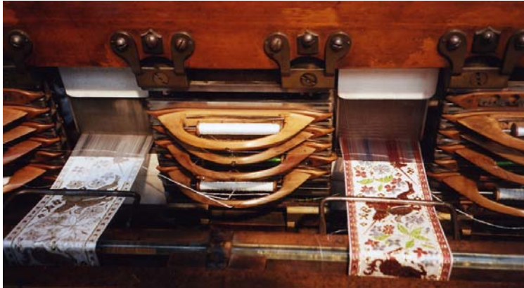
φωτ.1.20 Λεπτομέρεια αργαλειού για κορδέλες με μικρές σαΐτες που εισάγουν διαφορετικά υφάδια. (φωτ.: métiers.free.fr/deanuts/images/metiers1_g.jpg )
