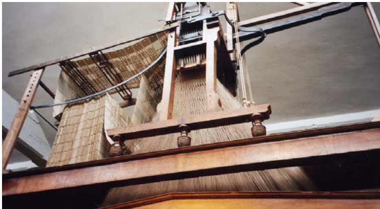
φωτ. 1.28 ο μηχανισμός του ζακάρ στο πάνω μέρος του αργαλειού με τις διάτρητες καρτέλες (φωτ.: métiers.free.fr/deanuts/images/metiers1_g.jpg)
