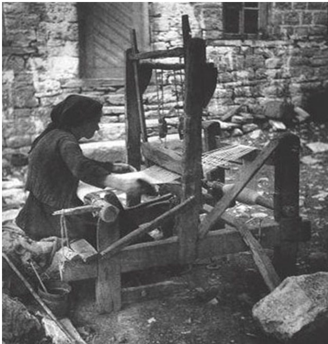
φωτ.1.9 παραδοσιακός ξύλινος αργαλειός με πεντάλ, Ευρυτανία, (φωτ.: www.evrytan.gr/images/argalios )
