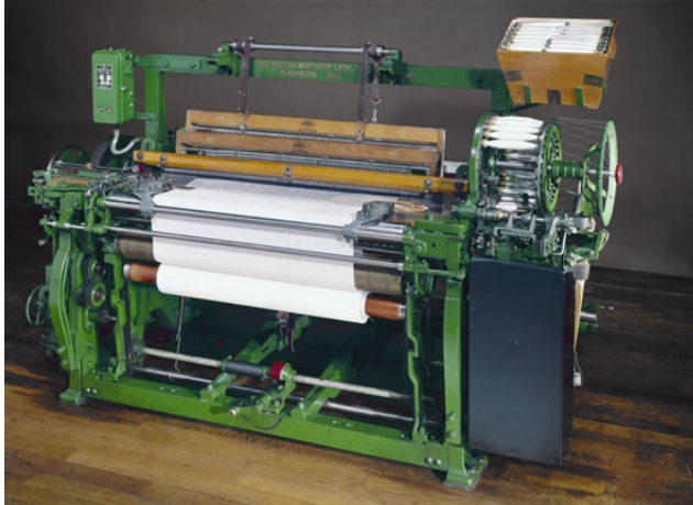
φωτ.1.32 Αυτόματος Αργαλειός: Northrup single-shuttle 'S' loom, 1939. Ο αργαλειός αυτός που αναπτύχθηκε στην Αμερική ήταν μία μεγάλη βελτίωση των προκατόχων του και είχε μεγάλη εμπορική επιτυχία (© Science Museum/Science and Society Picture Library)
