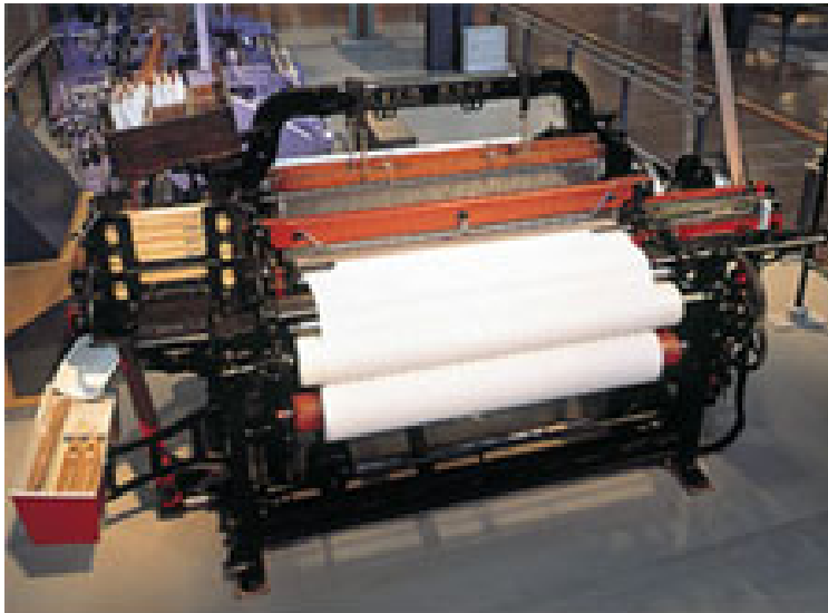
φωτ. 1.33 Ο αυτόματος αργαλειός Type G της Toyota (1924) φωτ.: Toyota Commemorative Museum of Industry and Technology, www.nagoya-cci.or.jp/mono/innovation_e.html
