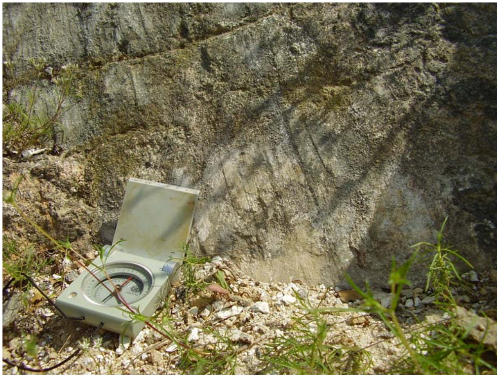
Φωτογραφία 2. Μέτρηση των γεωμετρικών χαρακτηριστικών του ρήγματος με χρήση γεωλογικής πυξίδας. Η διεύθυνση του ρήγματος σε αυτό το σημείο είναι Α-Δ. ( \Delta_{\kappa}:4^{\circ} ).
