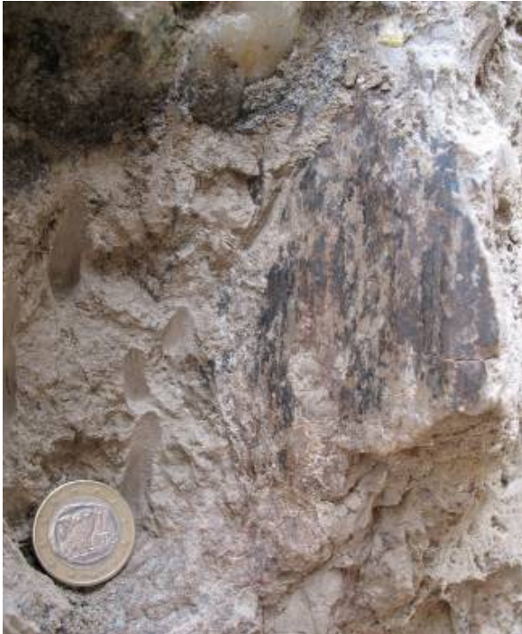
Φωτογραφία 6.5. Εμφάνιση της επιφάνειας του ρήγματος με αποτυπωμένες τις γραμμώσεις τεκτονικής ολίσθησης σε μαργαϊκά υλικά που βρέθηκαν στον πυθμένα της τάφρου. (Πηγή: Ζερβοπούλου et al., 2007).
