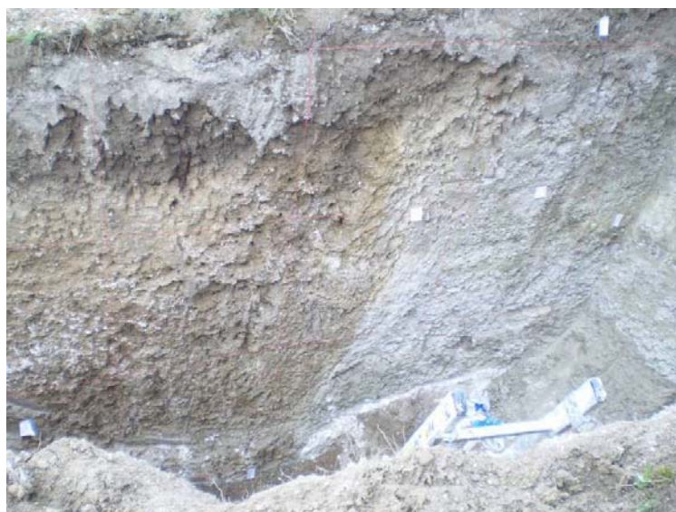
Φωτογραφία 6.4. Η χαρακτηριστική εμφάνιση του ρήγματος στην δεύτερη τάφρο ανάμεσα σε διαφορετικούς γεωλογικούς σχηματισμούς. (Πηγή: Ζερβοπούλου et al., 2007).
