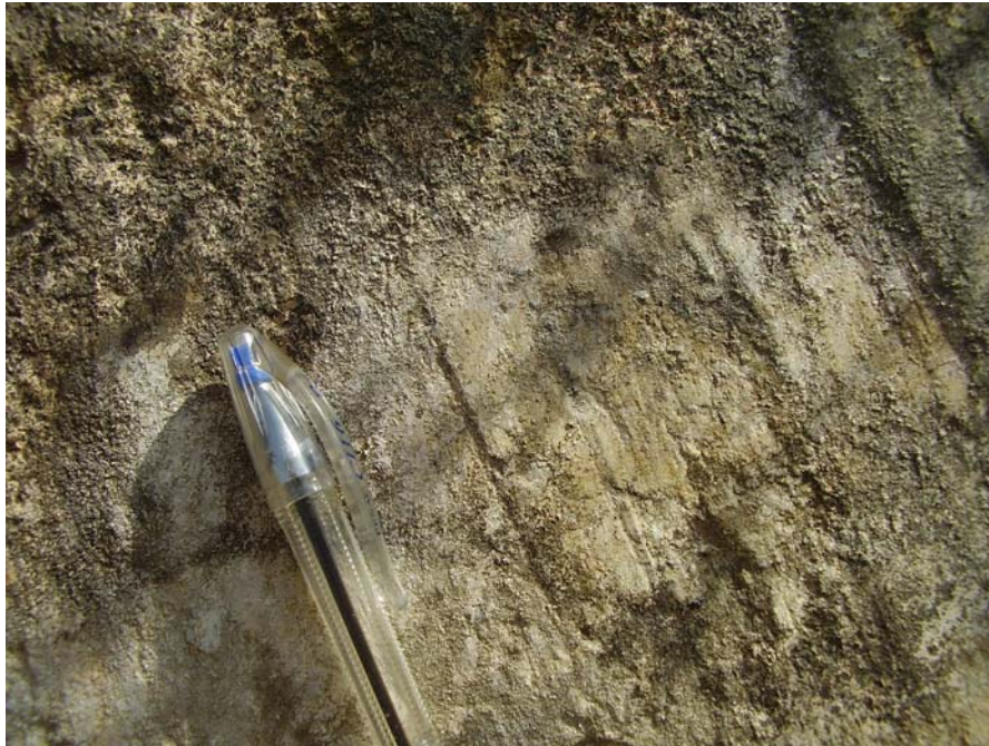
Φωτογραφία 3. Αποτύπωση της γράμμωσης τεκτονικής ολίσθησης πάνω στον καθρέφτη του ρήγματος που αποδεικνύει την κανονική, έως πλάγιο-κανονική (αριστερόστροφη) κίνηση του ρήγματος. (γωνία pitch 55°).
