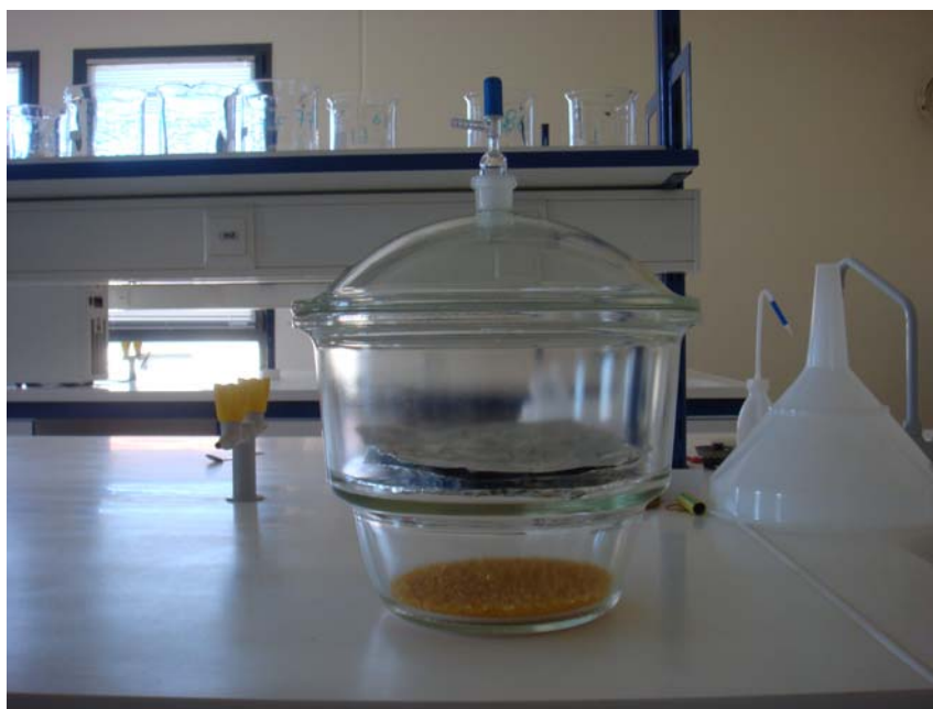
Σχήμα 7. Ο ξηραντήρας που χρησιμοποιήθηκε για την απομάκρυνση της υγρασίας στα δείγματα ζωοπλαγκτού.
