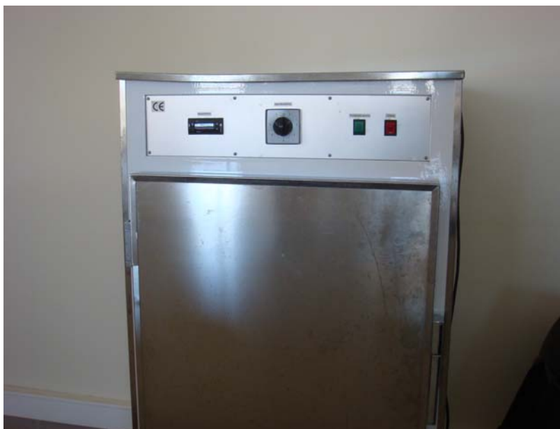
Σχήμα 8. Ο κλίβανος που χρησιμοποιήθηκε για την ξήρανση στους 60 °C των δειγμάτων ζωοπλαγκτού.
