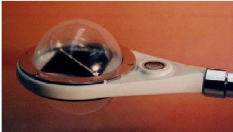
Εικόνα 2.22: Albedometer Middleton CNR-1 Net Radiometer
