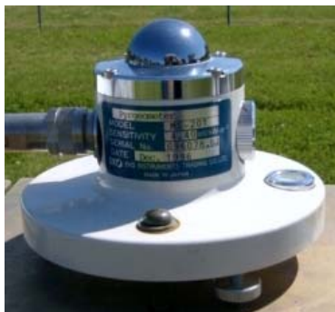
Εικόνα 2.23 : Pyrgeometer μοντ. MS-201 της EKO
