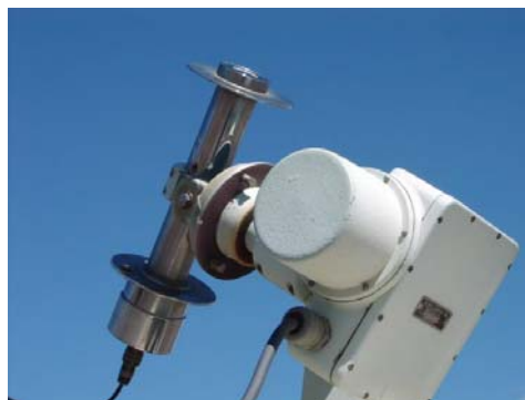
Εικόνα 2.21 : Pyrheliometer σε διαδικασία σκόπευσης (μέτρησης)
