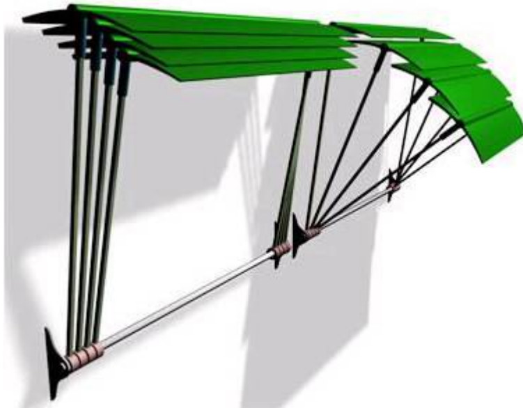
Σχήμα 6.11 : Ο περιορισμός προσανατολισμού ευθυγραμμίζει την τέντα στο υποστήριγμα της βέργας
