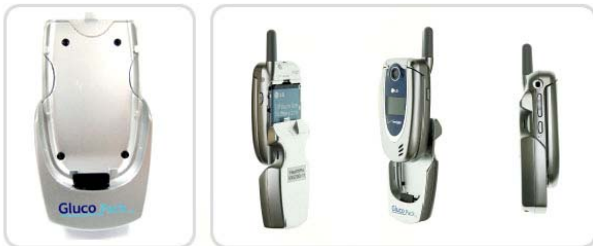
Εικόνα 48. Το GlucoPack της HealthPia America ενσωματωμένο σε συσκευή κινητής τηλεφωνίας (GlucoPhone) της ίδιας εταιρίας.
