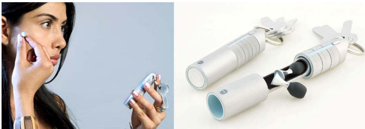
Εικόνα 81. Η συσκευή Decibel προστατεύει την ακοή του χρήστη από τα θορυβώδη περιβάλλοντα, ενώ ταυτόχρονα επιτρέπει σε συγκεκριμένους ήχους να περνάνε. Μπορεί να συνδεθεί με κινητό τηλέφωνο, φορητό υπολογιστή ή συσκευή αναπαραγωγής mp3.
