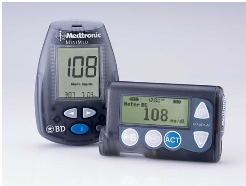
Εικόνα 47. Το σύστημα Paradigm REAL-Time της MiniMed. Αριστερά είναι η διαγνωστική συσκευή (μετρητής γλυκόζης), ενώ δεξιά η παρεμβατική συσκευή (αντλία ινσουλίνης).
