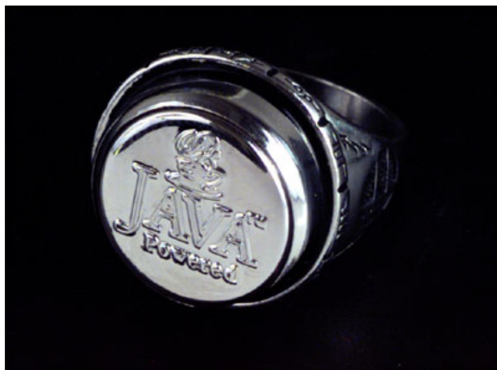
Εικόνα 21. Δαχτυλίδι προγραμματιζόμενο σε γλώσσα Java που μπορεί να λειτουργήσει ως κλειδί για πόρτες και συσκευές.
