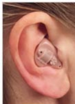
Εικόνα 2. Ακουστικό βαρηκοΐας τύπου In The Ear.
