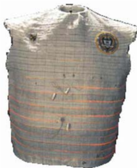
Εικόνα 3.13 Το Georgia Tech Wearable Motherboard περιλαμβάνει ηλεκτρικά αγώγιμες ίνες και πλαστικές οπτικές ίνες για τη μεταφορά πληροφοριών από αισθητήρες σε μονάδες επεξεργασίας
