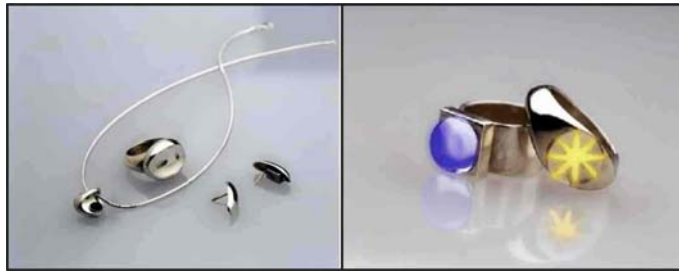
Εικόνα 3.41 Το κινητό τηλέφωνο, υπό τη μορφή κοσμημάτων, και το δαχτυλίδι της IBM, που αναβοσβήνει υποδεικνύοντας τις εισερχόμενες κλήσεις ή τη λήψη νέου e-mail, έχουν σκοπό να αλλάξουν τον τρόπο αλληλεπίδρασης των χρηστών με τους υπολογιστές και τις ηλεκτρονικές συσκευές.
