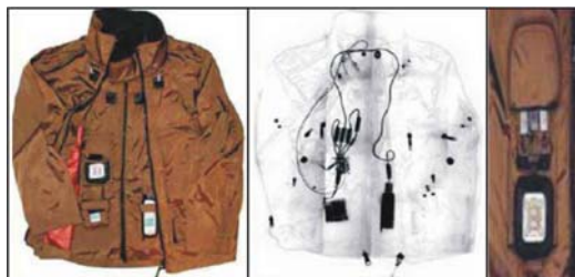
Εικόνα 3.20 Το μπουφάν της συνεργασίας της Levi Strauss με τη Philips και το ενσωματωμένο σύστημα επικοινωνιών της Izarek
