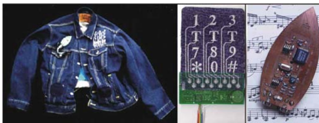
Εικόνα 3.22 α, β, γ Το Levi's Musical Jean Jacket , το υφασμένο από αγώγιμα νήματα πληκτρολόγιο και το MIDI συνθεσάιζερ
