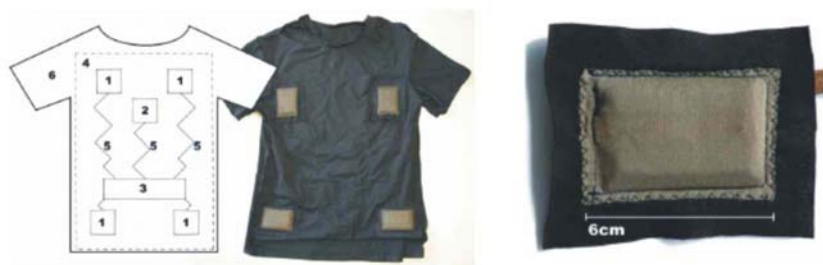
Εικόνα 3.11 Το σχεδιάγραμμα του ενδύματος, το T-shirt από την ανάποδη πλευρά και το υφασμάτινο ηλεκτρόδιο
