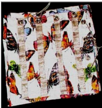
Εικόνα 4.9 Το υφασμάτινο ηλεκτρολόγιο αποτελείται από κομμάτια αγωγίμου και μη αγωγίμου υφάσματος ραμμένα μεταξύ τους
