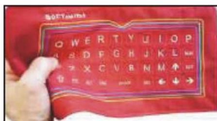
Εικόνα 3.4 Υφασμάτινο πληκτρολόγιο qwerty από τη SOFTswitch
