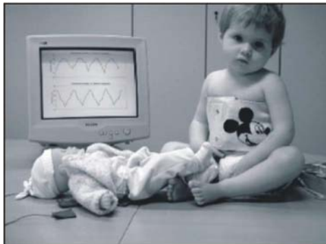
Εικόνα 3.2 Η Respibelt διαθέτει αισθητήρες από ίνες ανοξειδωτού ατσάλιου μέσα στην ύφανση και ενδείκνυται ακόμα για μακροπρόθεσμη παρακολούθηση της αναπνοής χωρίς να προκαλεί ερεθισμούς
