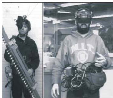
Εικόνα 2.2 Ο Steve Mann, το 1981 φορώντας τη συσκευή wearable computing που κατασκεύασε (αριστερά) και στις αρχές του 1990 φορώντας ένα πιο εξελιγμένο μοντέλο (δεξιά)
