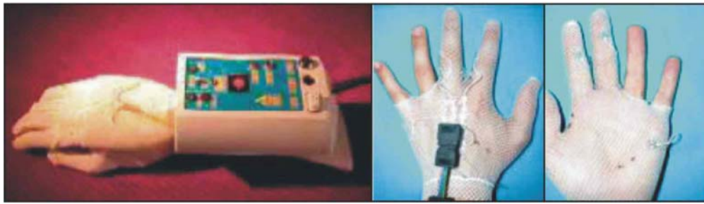
Εικόνα 3.7 Το MARSIAN είναι ένα αρθρωτό αυτόνομο καταγραφής σύστημα για τη μέτρηση της δραστηριότητας του ΑΝΣ που αποτελείται από έξυπνα ενδύματα, γάντια και μια συσκευή για τον καρπό
