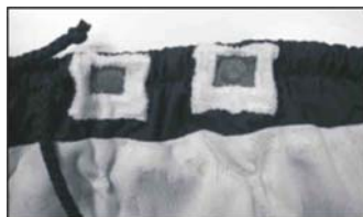
Εικόνα 3.12 Οι αγώγιμες πλάκες του συστήματος μέτρησης της βιοαντίστασης στη ζώνη του παντελονιού
