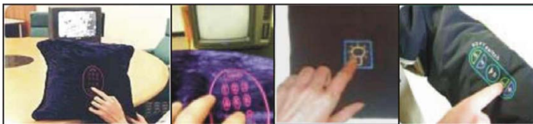
Εικόνα 3.3 Υφασμάτινο τηλεχειριστήριο σε μαξιλάρι καναπέ, διακόπτης φωτός σε κουρτίνα και χειριστήριο για την αναπαραγωγή μουσικής σε σπορ ένδυμα κατασκευασμένα από τη SOFTswitch (2001)
