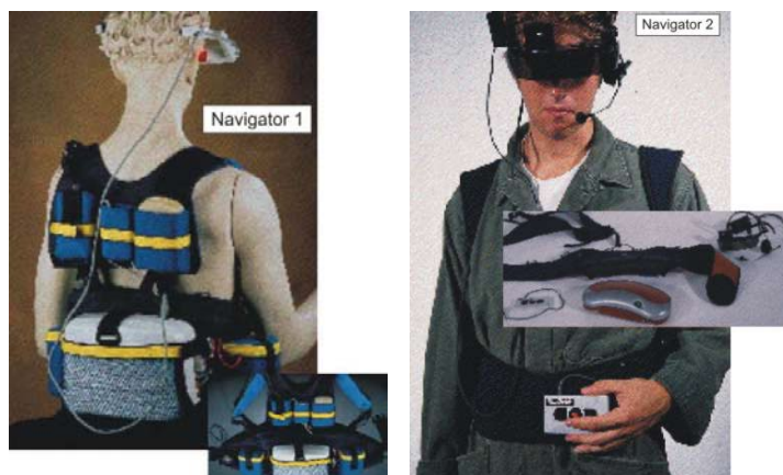
Εικόνα 2.21 α, β Οι φορέσιμοι υπολογιστές Navigator 1 , Navigator 2
