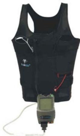
Εικόνα 3.15 Το LifeShirt της VivoMetrics είναι ένα σύστημα το οποίο χρησιμοποιείται σε πάνω από 1000 νοσοκομεία παγκοσμίως για την παρακολούθηση ασθενών
