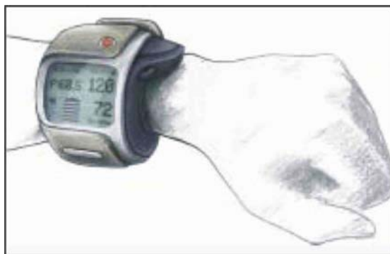
Εικόνα 2.7 Η συσκευή χεριός WMD (Wrist Monitoring Device) του φορέσιμου συστήματος AMON
