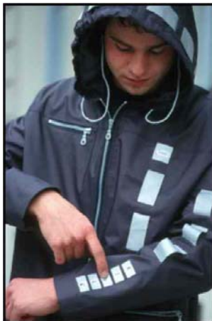
Εικόνα 4.8 Το σύστημα αναπαραγωγής MP3 που βρίσκεται ενσωματωμένο στο μπουφάν ελέγχεται με την ομιλία
