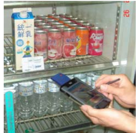
Εικ. 24. Η ανάγνωση δεδομένων από τους αισθητήρες RFID.
