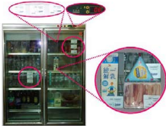
Εικ. 23. Η τοποθέτηση αισθητήρων RFID μέτρησης θερμοκρασίας στο ψυγείο.
