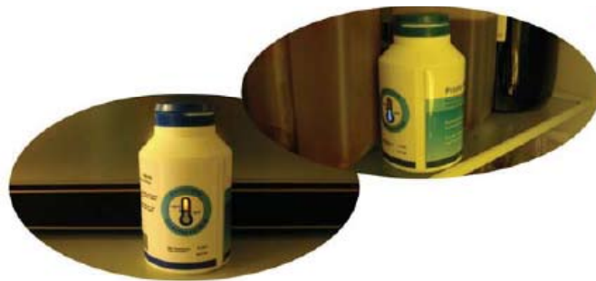
Εικ 2. Φαρμακευτική συσκευασία με χρωματικό δείκτη χρόνου θερμοκρασίας.
