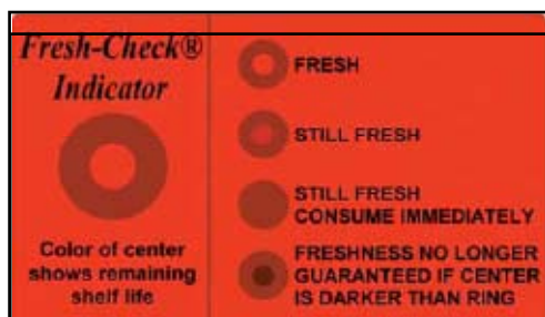
Εικ. 22. Δείκτες αλλαγής χρώματος που ελέγχουν την φρεσκάδα του τροφίμου. Το κέντρο της ετικέτας γίνεται μαύρο μετά το πέρασμα χρόνου και μέτρησης της θερμοκρασίας, δηλώνοντας τον προτεινόμενο χρόνο ζωής του προϊόντος.
