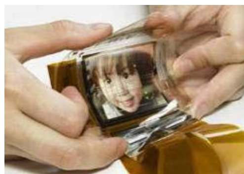
Εικ. 65 β: Δείγμα εύκαμπτης οθόνης που μπορεί να τοποθετηθεί σε μια τέτοιου τύπου συσκευασία από την εταιρεία Plastic Logic.
