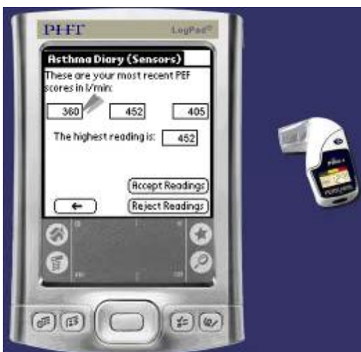
Εικ. 54. Εισαγωγή δεδομένων με ακρίβεια από συσκευές με αισθητήρες, όπως όργανο μέτρησης της αναπνοής. Με αυτόν τον τρόπο επιβεβαιώνεται ότι οι χρήστες χρησιμοποιούν τις συσκευές σωστά.
