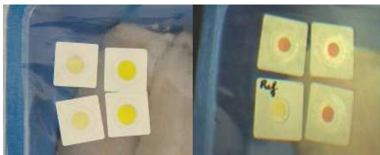
Εικ. 26. Η ανταπόκριση των αισθητήρων, με την αλλαγή χρώματος, κατά την αλλοίωση δείγματος.
