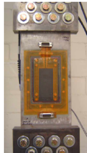
Σχήμα 1-18: Σειτ πιεζοηλεκτρικών αισθητήρων για τη παρακολούθηση της διάδοσης ρωγμής και των ατελειών σε ένα σύνθετο μάλωμα κολλημένο σε μεταλλικό δίσκο [7]
