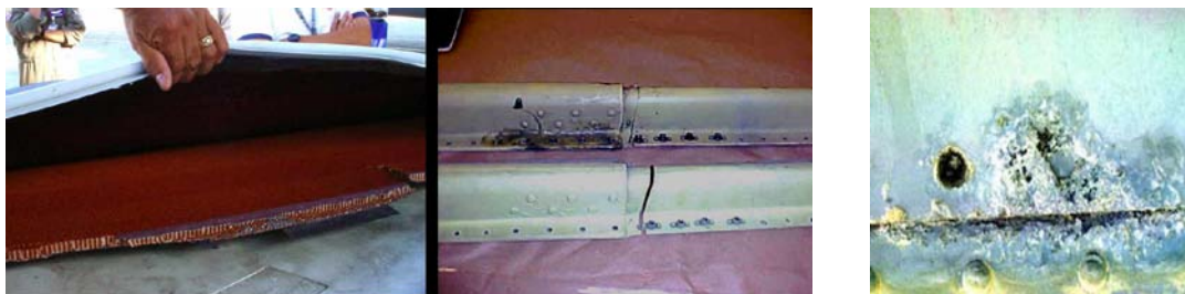
Συνθετικό στρώμα φλοιού ξεκολλημένο από τη κυψέλη
