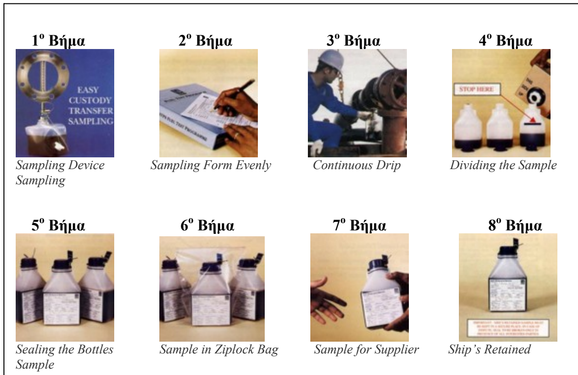
Σχήμα 5: Στάδια διαδικασίας δειγματοληψίας
