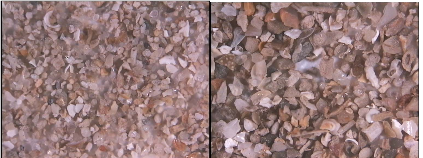
Εικ. I-26a (αριστερά): εποπτική, (63-125 \mu\text{m} ), (δεξιά): εποπτική, (125-250 \mu\text{m} )
