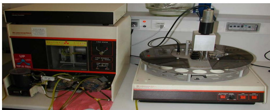
Εικ. 10. Συσκευή micromeritics Sedigraph 5100 των εργαστηρίων του Ελληνικού Κέντρου Θαλασσίων Ερευνών. Στο δεξί εξάρτημα γίνεται ομογενοποίηση του δείγματος με υπερήχους, ενώ στο αριστερό εξάρτημα οδηγείται το δείγμα σε κυψελίδα στην οποία προσπίπτει μαλακή ακτινοβολία X
