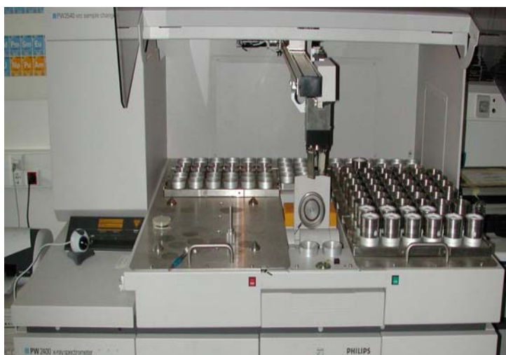
Εικ. 13α: Φθορισόμετρο ακτίνων X (XRF) του ΕΛ.ΚΕ.Θ.Ε
