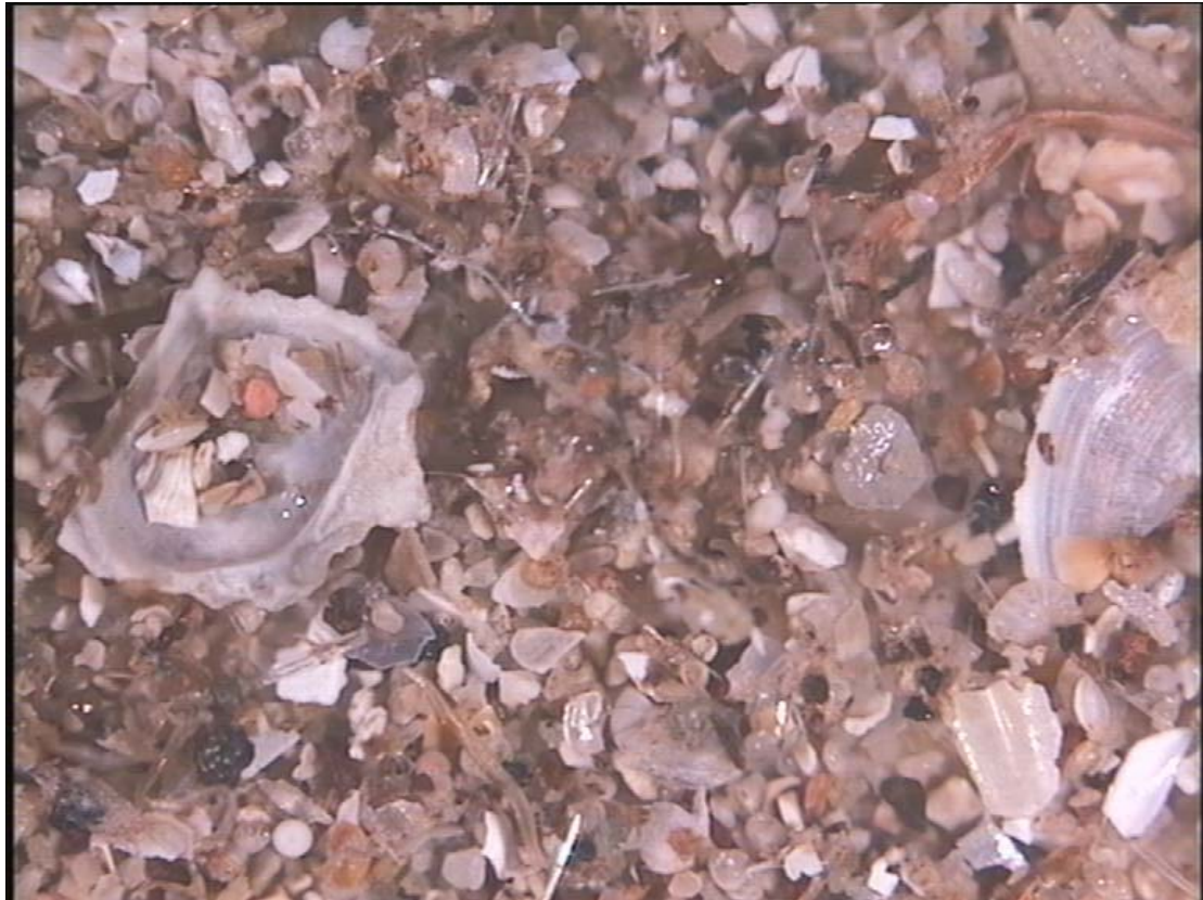
I-9: Το δείγμα αποτελείται από ψιλή – μέτρια άμμο. Χαλαζίας – άστριοι 20%, βιογενή 50% (κελύφη σε αναλογία 60%-40% από δίθυρα και γαστερόποδα μήκους από 0,2 mm έως 1,2 cm), έγχρωμα ορυκτά 30% και ίχνη βωξίτη.
