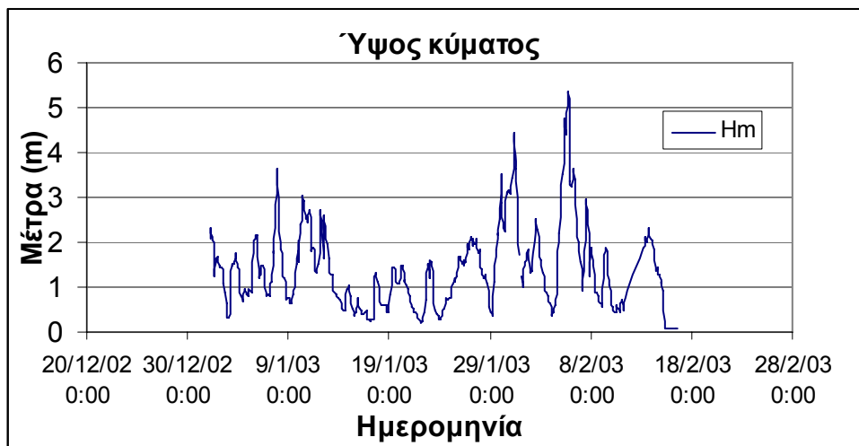
Σχήμα 4.24: Διάγραμμα ύψους κύματος κατά τη διάρκεια μετρήσεων του μετεωρολογικού σταθμού του συστήματος Poseidon στην περιοχή Σιγρίου της Λέσβου το Χειμώνα του 2003.
