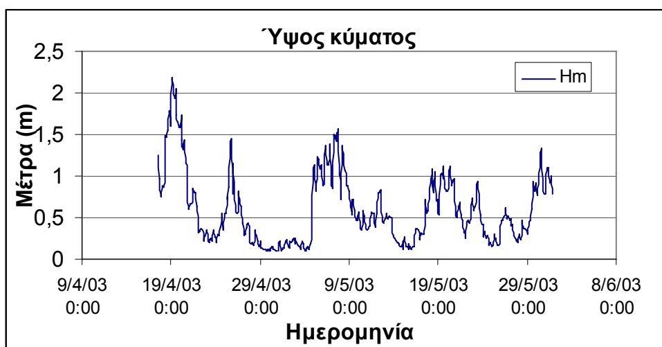
Σχήμα 4.25: Διάγραμμα ύψους κύματος κατά τη διάρκεια μετρήσεων του μετεωρολογικού σταθμού του συστήματος Poseidon στην περιοχή Σιγρίου της Λέσβου την Άνοιξη του 2003.
