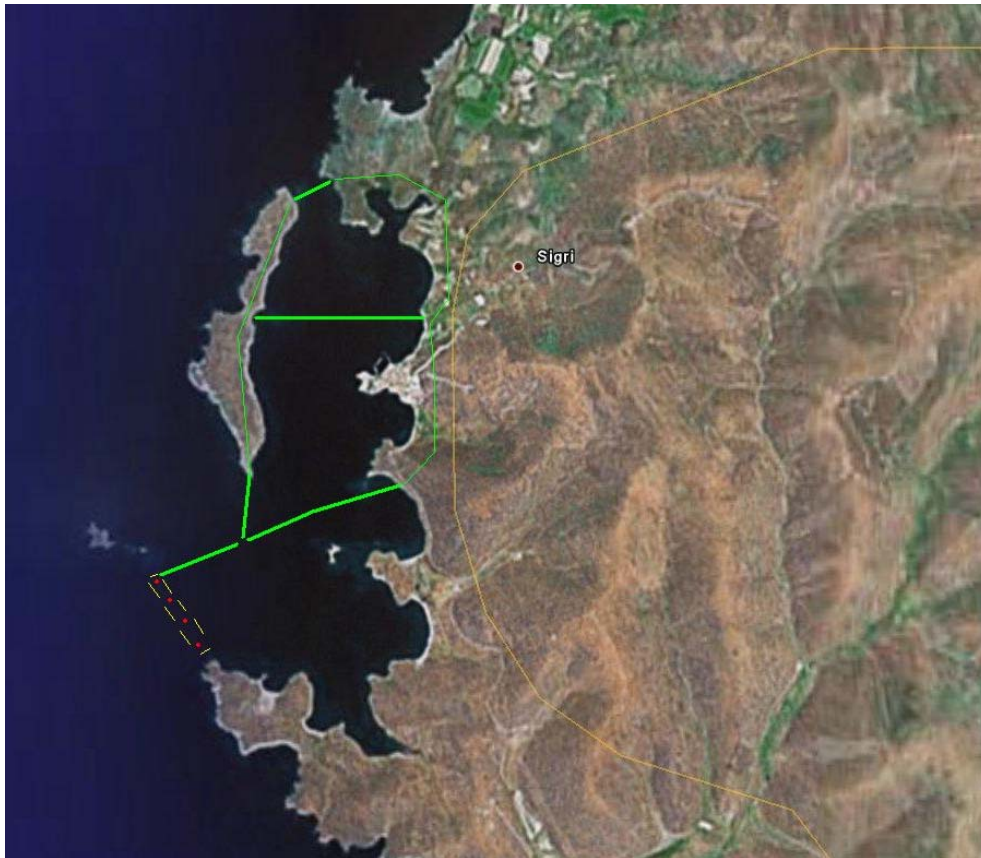
Σχήμα 6.8: Σχεδιασμός του θαλάσσιου αιολικού πάρκου. Με κόκκινο χρώμα απεικονίζονται οι ανεμογεννήτριες, ενώ οι πράσινες γραμμές αναπαριστούν τις επιλογές για την καλωδίωση του πάρκου με τη ξηρά.
