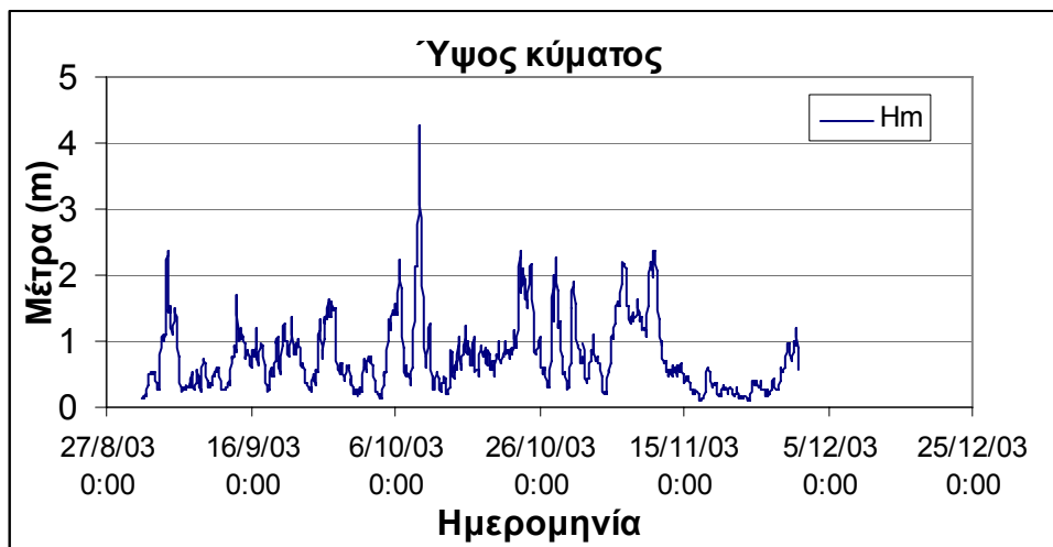
Σχήμα 4.27: Διάγραμμα ύψους κύματος κατά τη διάρκεια μετρήσεων του μετεωρολογικού σταθμού του συστήματος Poseidon στην περιοχή Σιγρίου της Λέσβου το Φθινόπωρο του 2003.
