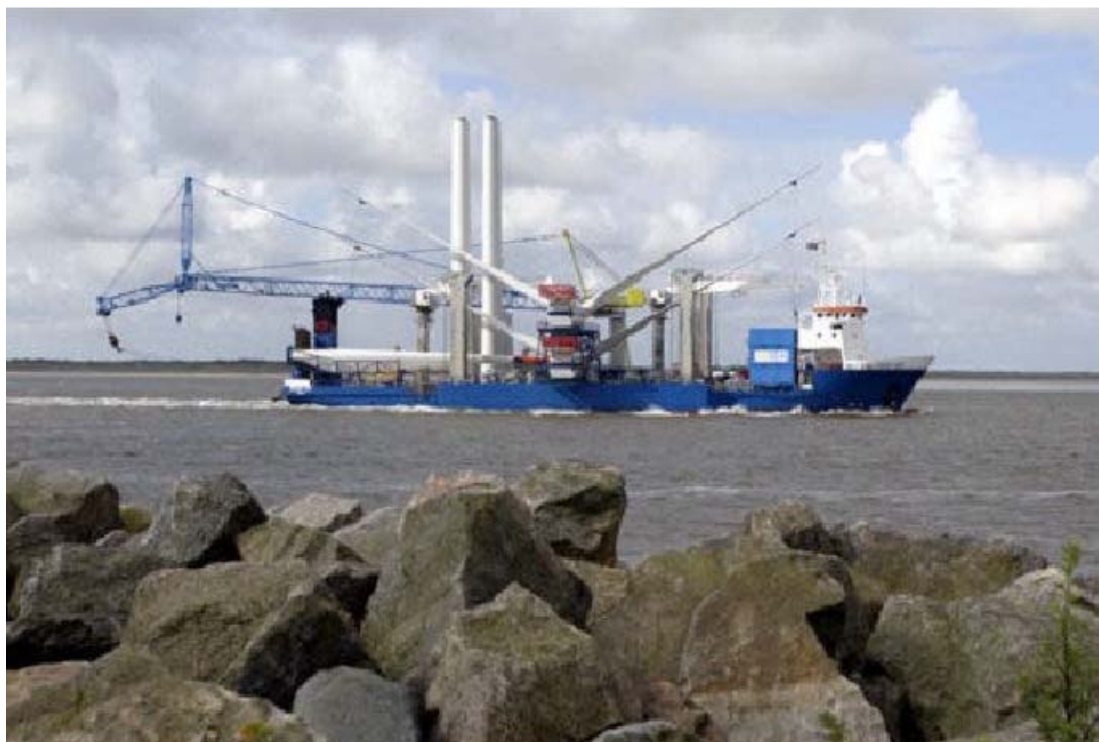
Σχήμα 8: Μεταφορά με ειδικό πλοίο εξοπλισμού της ανεμογεννήτριας. Διακρίνονται στο κατάστρωμα του, δύο κελύφη (το ένα πάνω στο άλλο) με δύο πτερύγια, ενώ μεταφέρονται και τα άλλα δύο πτερύγια που θα τοποθετηθούν στη μηχανή.
