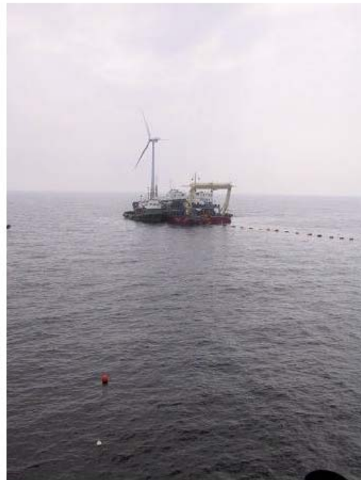
Σχήμα 12: α) Εγκατάσταση των καλωδίων σύνδεσης κατά τη φάση κατασκευής της θεμελίωσης. β) Ολοκλήρωση των εργασιών εγκατάστασης με τοποθέτηση προστατευτικών σημαντήρων γύρω από την ανεμογεννήτρια.
