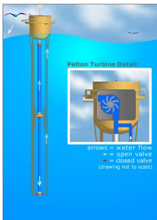
Σχήμα 3.6: Η λειτουργία του AquaBuoy όπως φαίνεται από τα βέλη. (Πηγή: http://aquaenergygroup.com )
