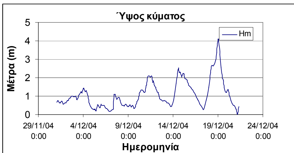
Σχήμα 4.32: Διάγραμμα ύψους κύματος κατά τη διάρκεια μετρήσεων του μετεωρολογικού σταθμού του συστήματος Poseidon στην περιοχή Σιγρίου της Λέσβου το Χειμώνα του 2005.
