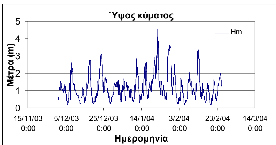
Σχήμα 4.28: Διάγραμμα ύψους κύματος κατά τη διάρκεια μετρήσεων του μετεωρολογικού σταθμού του συστήματος Poseidon στην περιοχή Σιγρίου της Λέσβου το Χειμώνα του 2004.
