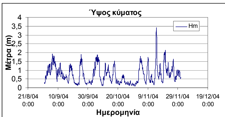
Σχήμα 4.31: Διάγραμμα ύψους κύματος κατά τη διάρκεια μετρήσεων του μετεωρολογικού σταθμού του συστήματος Poseidon στην περιοχή Σιγρίου της Λέσβου το Φθινόπωρο του 2004.
