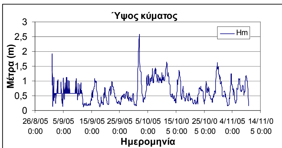
Σχήμα 4.35: Διάγραμμα ύψους κύματος κατά τη διάρκεια μετρήσεων του μετεωρολογικού σταθμού του συστήματος Poseidon στην περιοχή Σιγρίου της Λέσβου το Φθινόπωρο του 2005.
