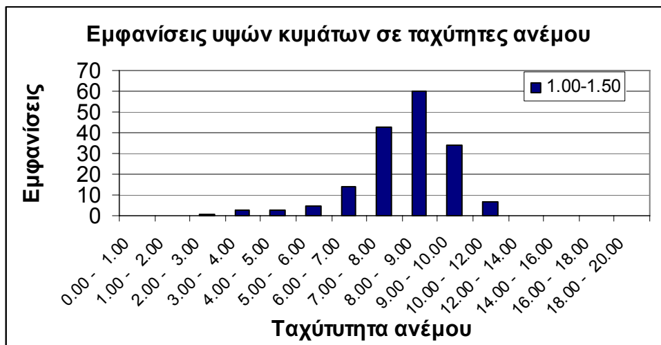
Σχήμα 4.18: Ραβδόγραμμα αριθμού εμφανίσεων υψών κυμάτων από 1-1,5μέτρα, σε διάφορες διευθύνσεις ανέμου.
