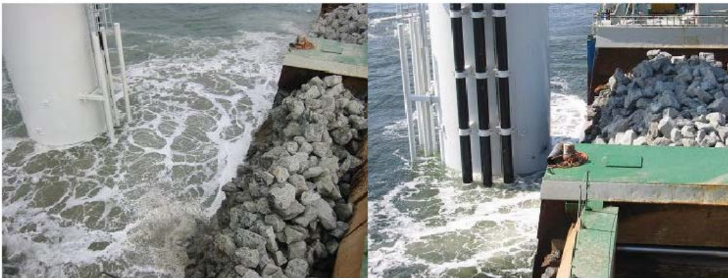
Σχήμα 5: Μεταφορά των χαλικιών από τη φορηγίδα. Αφού πλησιάσει τον πύργο, ένα έμβολο απωθεί από το σκάφος τα χαλίκια και παρασύρονται στο βυθό.
