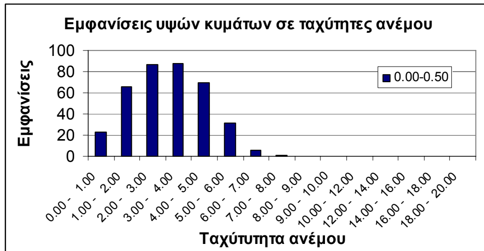
Σχήμα 4.16: Ραβδόγραμμα αριθμού εμφανίσεων υψών κυμάτων από 0-0,5μέτρα, σε διάφορες διευθύνσεις ανέμου.
