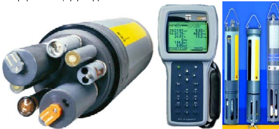
Εικόνα 1.15. Αριστερά: probe με πολλαπλούς αισθητήρες. Κέντρο: Φορητό όργανο μέτρησης. Δέχεται μια μεγάλη γκάμα probes και έχει δυνατότητα καταγραφής. Δεξιά: μεμονωμένα probes ή συνδυασμός 2-4 μετρήσεων από την ίδια κεφαλή (πηγή: SONTEK)
