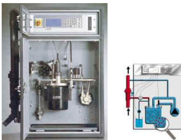
Εικόνα 1.11. Αριστερά, φωτογραφία οργάνου on-line μέτρησης BOD-M3 και δεξιά το διάγραμμα λειτουργίας του (πηγή: envitech.com)
