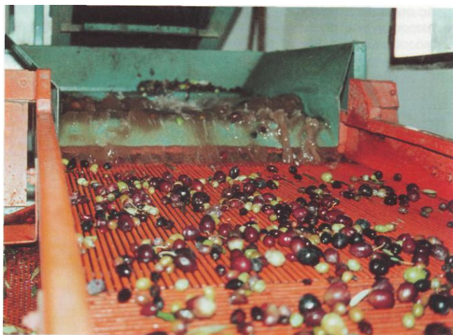
Εικόνα 3.3: Πλυντήριο ελαιουργικού συγκροτήματος
