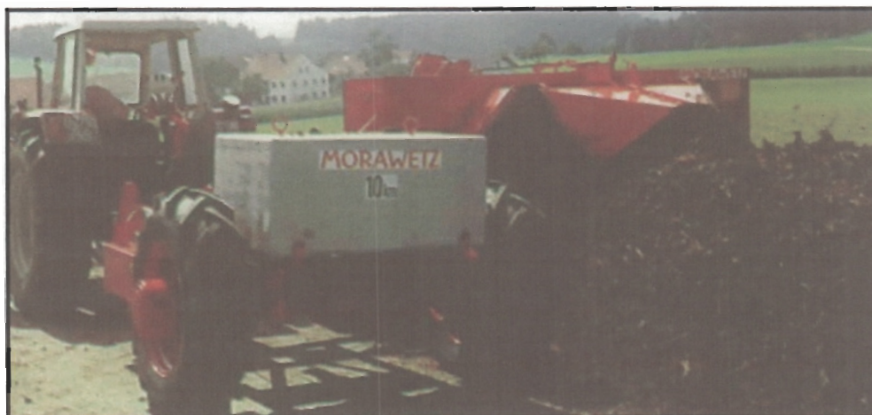
Εικόνα 19. Αναστροφέας σωρών κομποστοποίησης για γεωργικούς ελκυστήρες χωρίς έρπουσα ταχύτητα.
