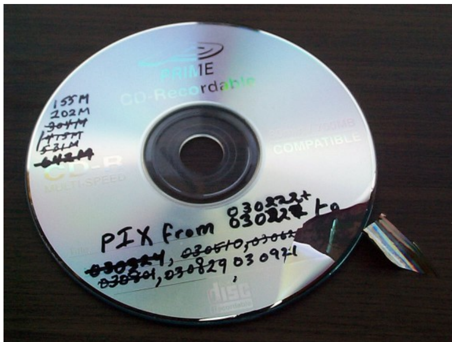
Φωτογραφία 37: Κατεστραμμένο CD (Το επάνω στρώμα έχει υποστεί διάβρωση)
