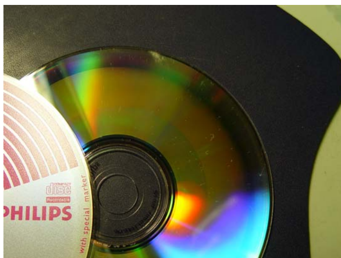
Φωτογραφία 35: Κατεστραμμένο CD (Ξένα σώματα και γρατσοονιές στην κάτω επιφάνεια)
