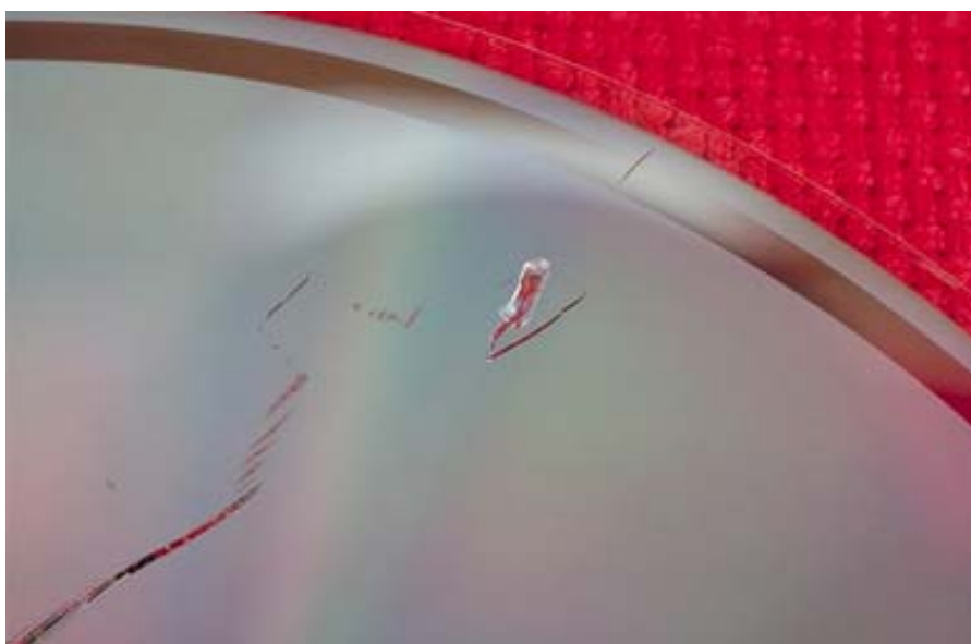
Φωτογραφία 34: Κατεστραμμένο CD (Λόγω Μηχανικής Καταπόνησης) (Πηγή: http://www.ifla.org/VI/6/dswmedia/en/loupe/vopti_h59.htm )
