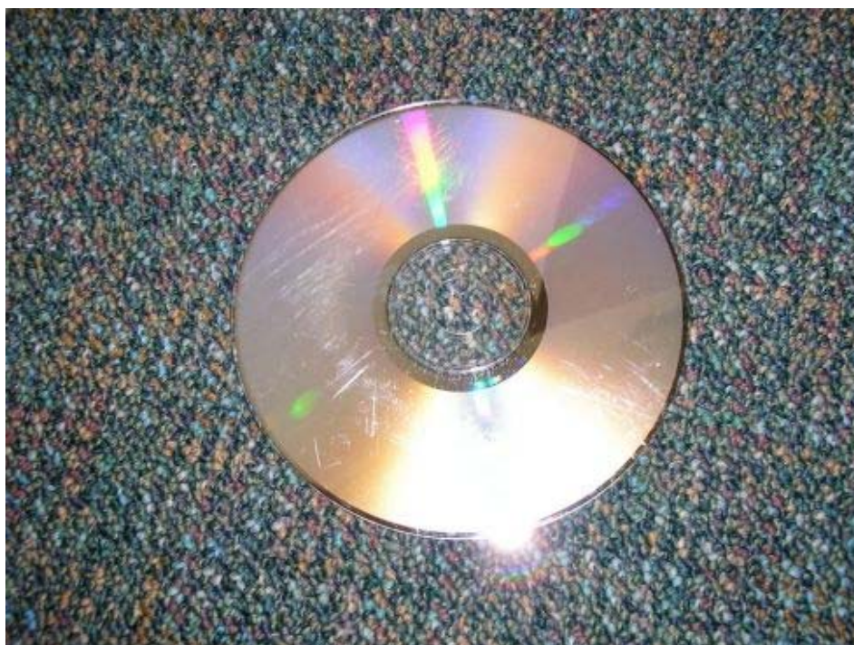
Φωτογραφία 33: Κατεστραμμένο CD (Γρατσουνιές στην κάτω επιφάνειά του)
