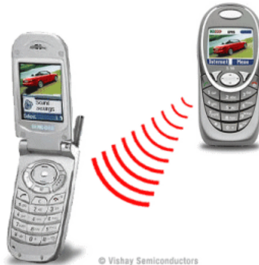
Εικόνα 1 - Η σύνδεση μεταξύ δύο συσκευών με τη χρήση infrared
