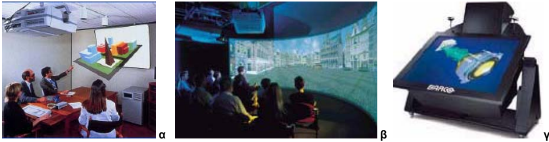
Εικ. 4.3 (α) Τρισδιάστατη οθόνη με γυαλιά, (β) Δισδιάστατη οθόνη μεγάλου μεγέθους και (γ) οθόνη Αφής
