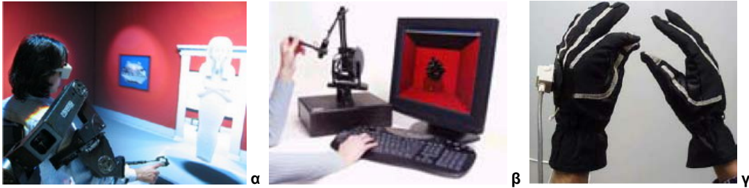
Εικ. 4.5 Συστήματα τρισδιάστατης απεικόνισης και ανάδρασης: (α) exoskeleton, (β) Phantom Premium 1.5 και (γ) γάντια με αισθητήρες
