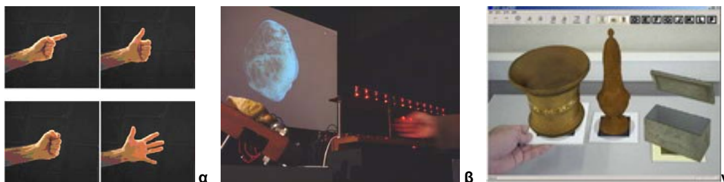
Εικ. 6.4 (α) Απτική διάδραση με αναγνώριση χειρονομιών (Nikolakis, 2004), (β) επιλογή αντικειμένου από κονσόλα με τοποθέτηση σφαίρας κάτω από αντίστοιχο αντικείμενο και περιστροφή εικονικού αντικειμένου με ταχύτητα που υπολογίζεται με αλγόριθμους βάση της κίνησης του χεριού που ανιχνεύουν ακτίνες λέιζερ τοποθετημένες στη σειρά σε ίσες αποστάσεις (Πεχλιβανίδης, 2000) (γ) διεπαφή με markers για την επιλογή και επεξεργασία αντικειμένων, για την απάντηση σε παιχνίδια γνώσεων, κ.ά. (Liarokaris, 2004).
