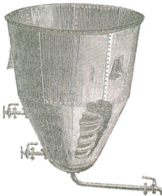
Εικόνα 28: Σαπυνοκάζανο με σερπαντίνα. Στο κάτω μέρος διακρίνεται και ο κρουνός εκκένωσης.
