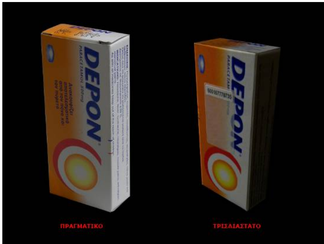
Εικόνα 2: Αποτελέσματα φωτογραμμετρικής αποτύπωσης ενός κουτιού παυσιπόνων.
