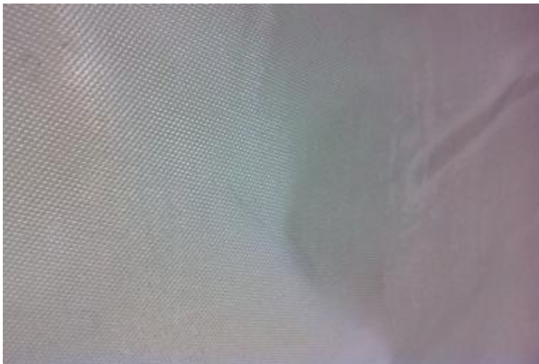
Εικόνα 35. Υαλονήματα Προεμποντισμένα με Εποξειδική Ρητίνη (300gsm).
