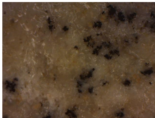
Εικ.49 Στερέωση επιφάνειας, δείγμα K4- S305 (Φωτογραφία από μικροσκόπιο LED μεγέθυνσης x200)
