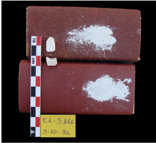
Εικ.32 Λείανση θραυσμάτων, του δείγματος K4-S146, για εγκιβωτισμό
