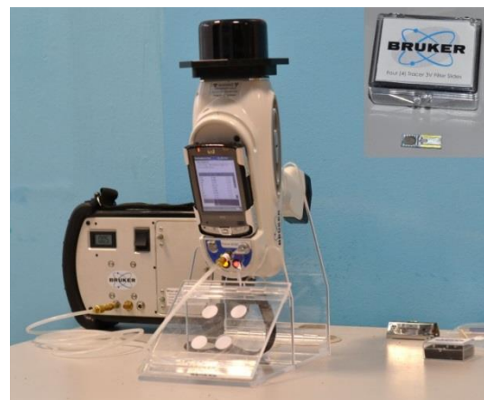
Εικ.31 Φορητό XRF Tracer III-SD της Bruker, αντλία και yellow φίλτρο.
