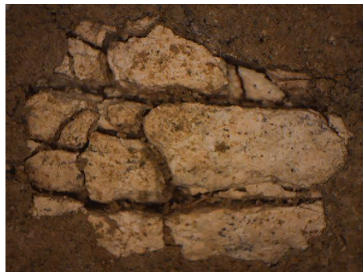
Εικ.41 Ρηγμάτωση και γεωλογικό υλικό εσωτερικά των ρωγμών, δείγμα K4-S146 (Φωτογραφία από μικροσκόπιο LED μεγέθυνσης x10)
