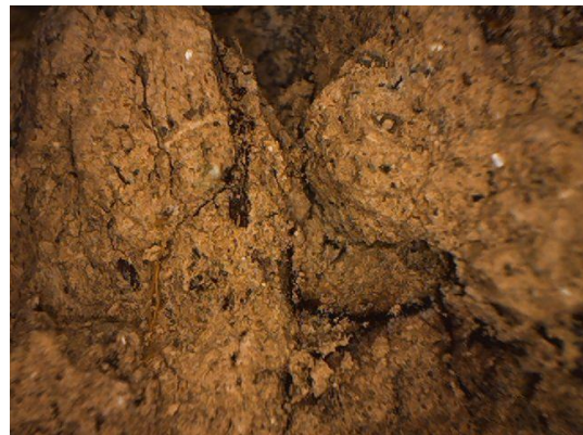
Εικ.47 Ίνες στο γεωλογικό υλικό, δείγμα K4-S305 (Φωτογραφία από μικροσκόπιο LED μεγέθυνσης x10)
