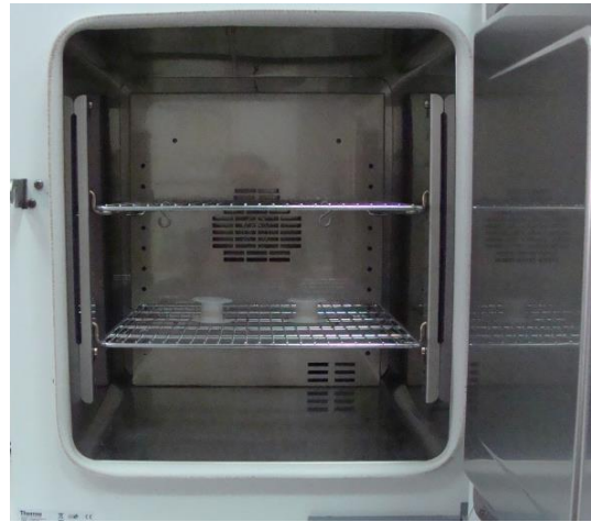
Εικ.33 Τοποθέτηση εγκιβωτισμένων δειγμάτων στον κλίβανο
