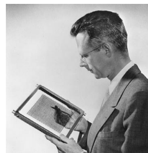
Εικόνα 8 Coincident Coil Magnetic Core Memory: Ο Jay Forrester κρατώντας ένα 64x64 core memory plane, 1954. Η φωτογραφία χρησιμοποιείται με την άδεια της MITRE Corporation. Copyright © The MITRE Corporation. All Rights Reserved. (Lane & Sterman, 2011)
