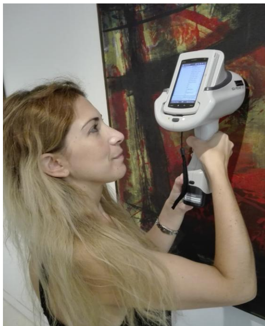
εικ.4.2.1. Μετρήσεις με φορητό XRF.
