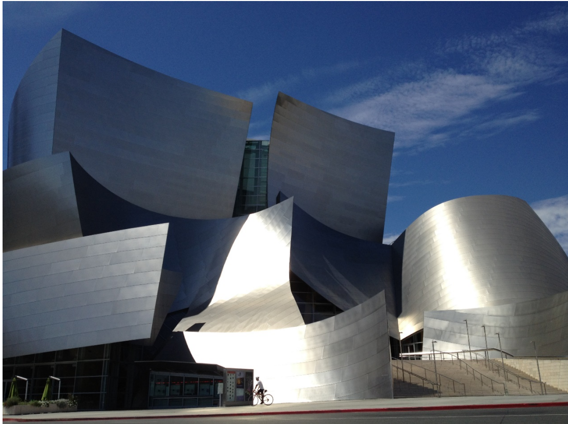
Εικόνα 3. 8: Διαφορετικές τιμές λαμπρότητας για επιφάνειες με ίδιο βαθμό ανάκλασης, λόγω διαφορών στο φως που προσπίπτουν σε αυτές.
