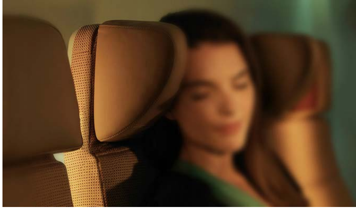
Εικόνα 1. 15: Παράδειγμα ενισχυμένου πλαϊνού που διευκολύνει τη στήριξη του κεφαλιού.
