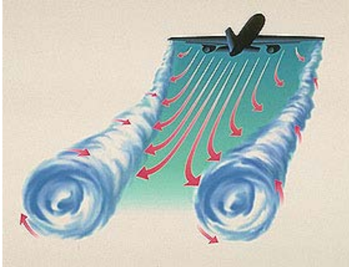
Εικόνα 2. 16: Δίνες ακροπτερυγίου, δημιουργούμενες από την κυκλική κίνηση του αέρα γύρω από το ακροπτερύγιο.
