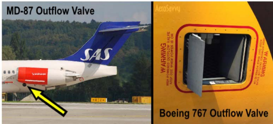
Εικόνα 4. 13: Η βαλβίδα εκροής αερίων και απελευθέρωσης πίεσης του αεροσκάφους.
