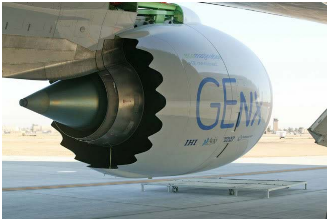
Εικόνα 2. 9: Πριονωτά μοτίβα στο ακροφύσιο ενός κινητήρα, που ονομάζονται chevrons.
