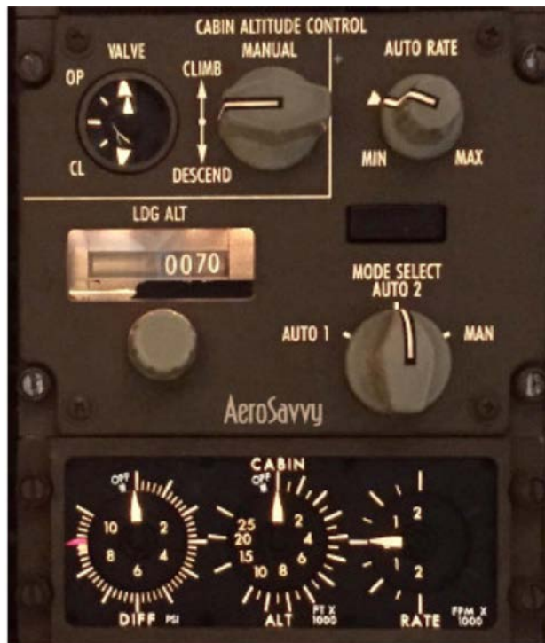
Εικόνα 4. 20: Σύστημα ελέγχου πίεσης των Boeing 757 & 767.
