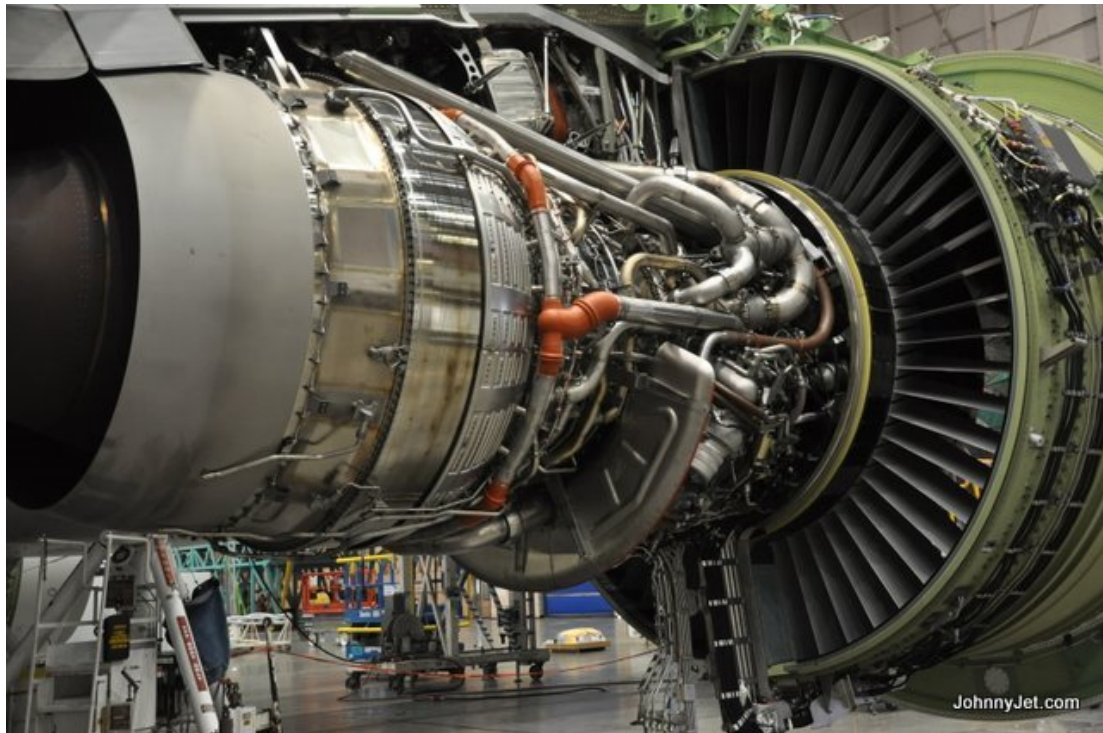
Εικόνα 2. 7: Όψη κινητήρα ενός Boeing 777 εσωτερικά από το περίβλημά του.
