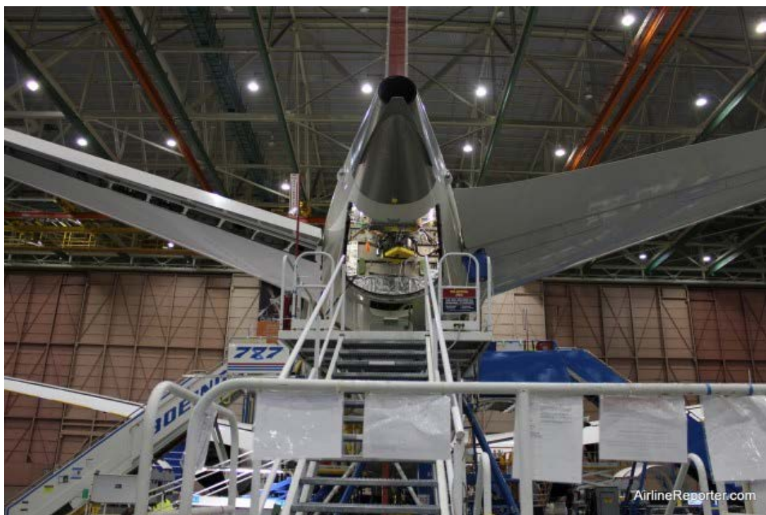
Εικόνα 2. 8: Η βοηθητική μονάδα ισχύος ενός Boeing 787 στο πίσω μέρος του αεροσκάφους.
