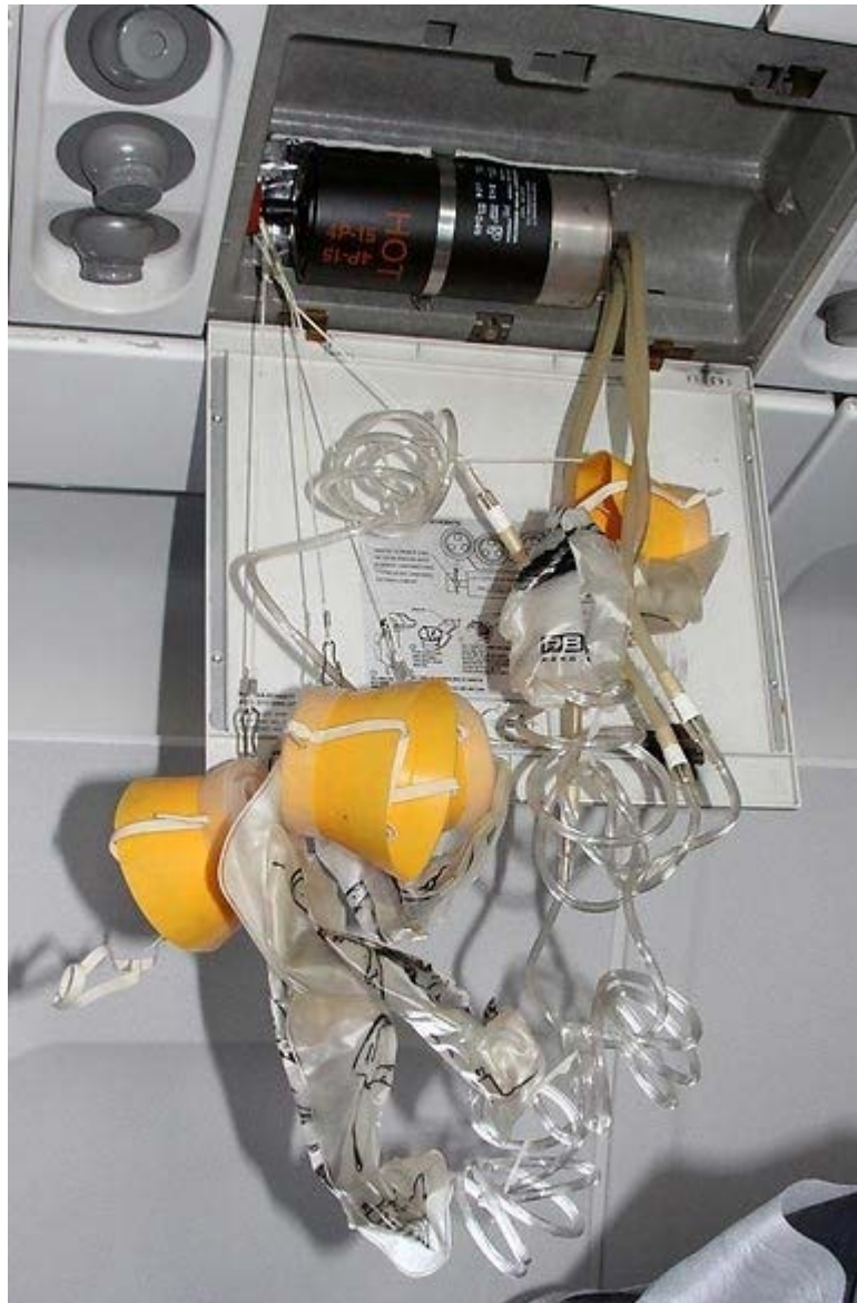
Εικόνα 4. 21: Μηχανισμός παραγωγής οξυγόνου και ατομικές μάσκες.
