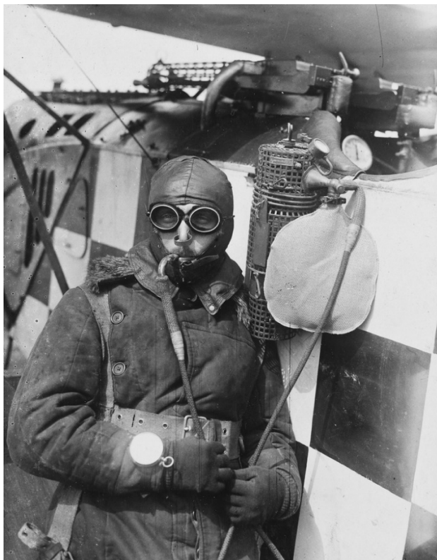
Εικόνα 4. 10: Πρόσληψη οξυγόνου από δεξαμενή πεπιεσμένου οξυγόνου, με τη χρήση σωλήνα.
