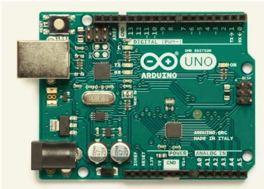
Σχήμα 1.10: Η κλασική πλακέτα Arduino με επεξεργαστή AVR των 8 bit
