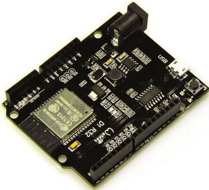
Σχήμα 6.1: Η Arduino like πλακέτα με τον ESP 32.
