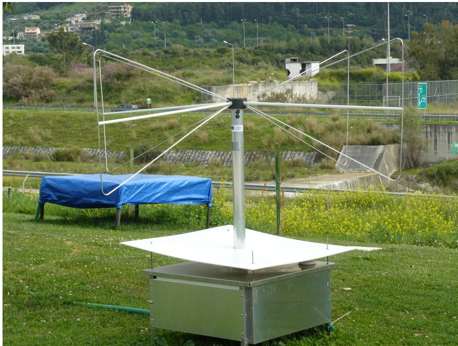
Εικόνα 4.9: Η κεραία τύπου Codalema, στο βάθος διακρίνεται εγκατεστημένος ένας ανιχνευτής σπινθηρισμού.
