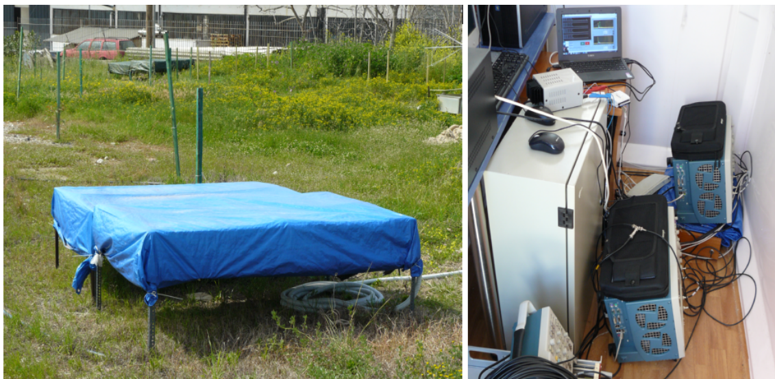
Εικόνα 7.2: Αριστερά: απεικόνιση της τοποθέτησης των ανιχνευτών για τη βαθμονόμηση των σταθμών και Δεξιά: απεικόνιση των 2 παλμογράφων που πραγματοποιούν τη λήψη δεδομένων και του υπολογιστή (laptop) που μέσω πακέτου λογισμικού DAQ, ελέγχει τη διαδικασία.
