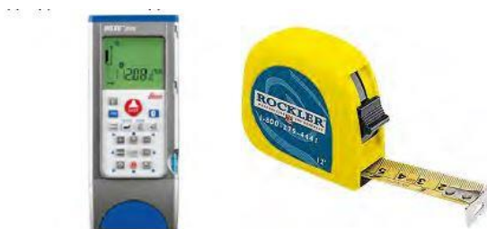
Εικόνα 2.2: Απλά όργανα μετρήσεων: αποστασιόμετρο λέιζερ και μεταλλικό μέτρο.
