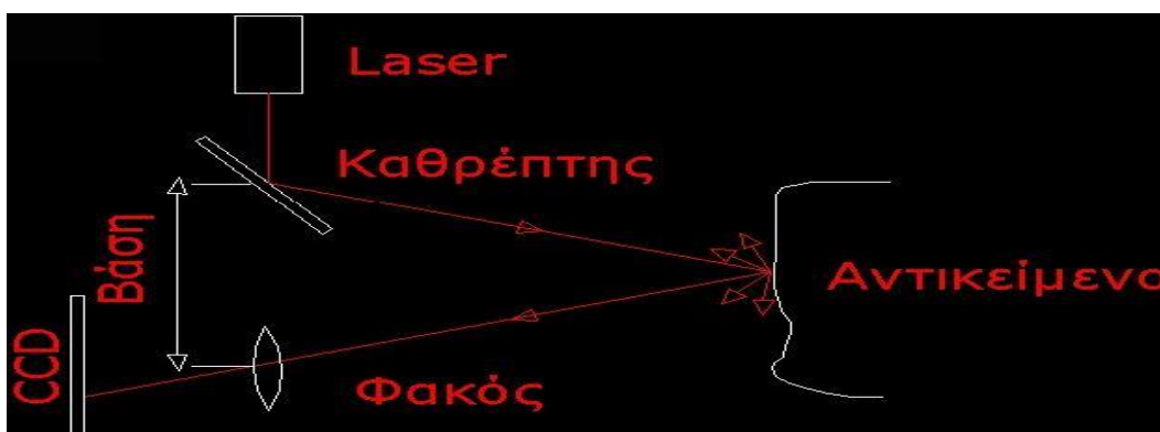
Εικόνα 2.4: Μέθοδος τριγωνισμού για τον υπολογισμό των συντεταγμένων των σημείων.
