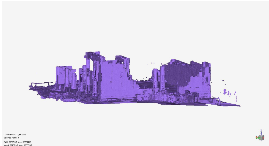
Εικόνα 4.22: Το πυκνό νέφος σημείων όπως απεικονίζεται στο λογισμικό του Geomagic , πριν την επεξεργασία και την αφαίρεση θορύβου
