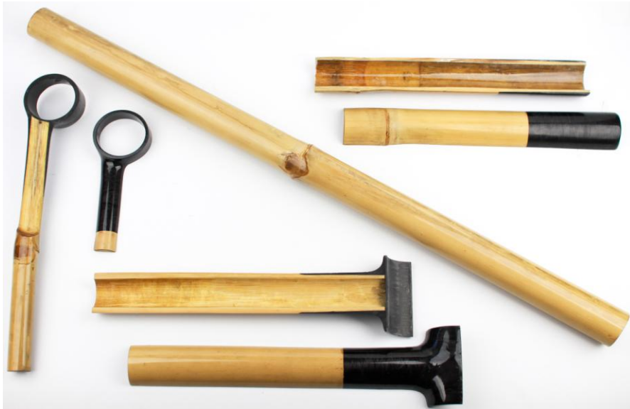
Εικόνα 18: Διάφορα μέρη ποδηλατικού πλαισίου, αποτέλεσμα συνδυασμού ξύλου μπαμπού και ινών άνθρακα.
