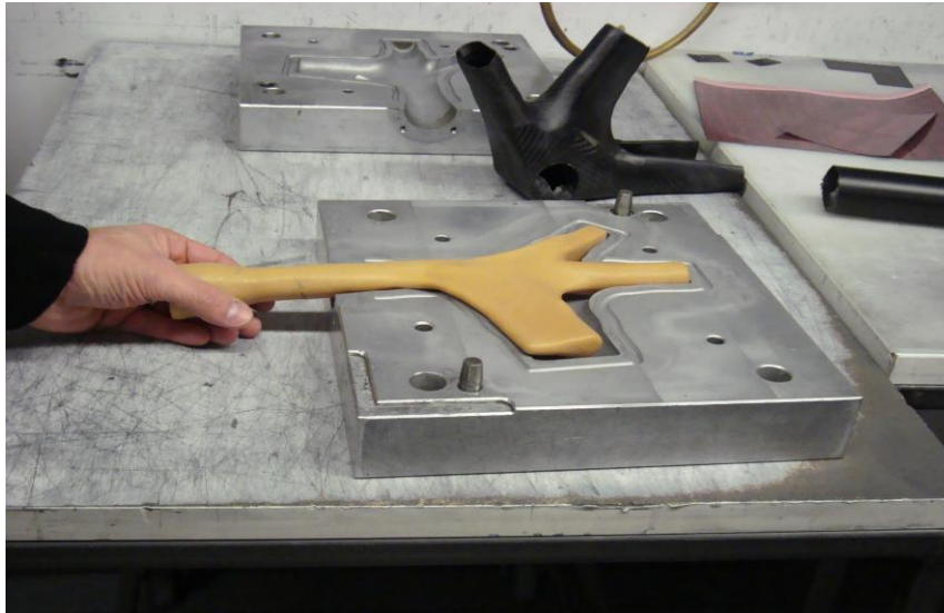
Εικόνα 16: Διαιρετό καλούπι για τη δημιουργία επιμέρους εξαρτήματος ποδηλατικού πλαισίου.
