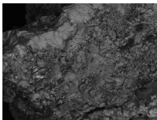
Εικ. Γ44. Δείγμα από τα ψήγματα Cu(s), στο SEM \times 230 , οπισθοσκεδαζόμενα
