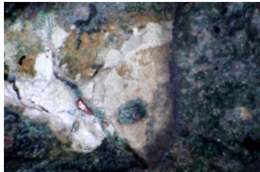
Εικ. Γ29. Το λευκό στρώμα 4 στο περιχέλιωμα της εφηλίδας, ανάμεσα στο τραχύ στρώμα 1. Δευτερογενής χαλκός έχει πληρώσει τη ρωγμή και έχει μερικώς διαβρωθεί
