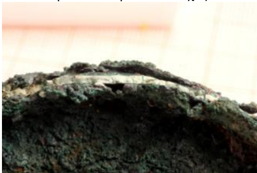
Εικ. Γ29. Το λευκό στρώμα 4 στο περιχέλιωμα της εφηλίδας, ανάμεσα στο τραχύ στρώμα 1. Δευτερογενής χαλκός έχει πληρώσει τη ρωγμή και έχει μερικώς διαβρωθεί
