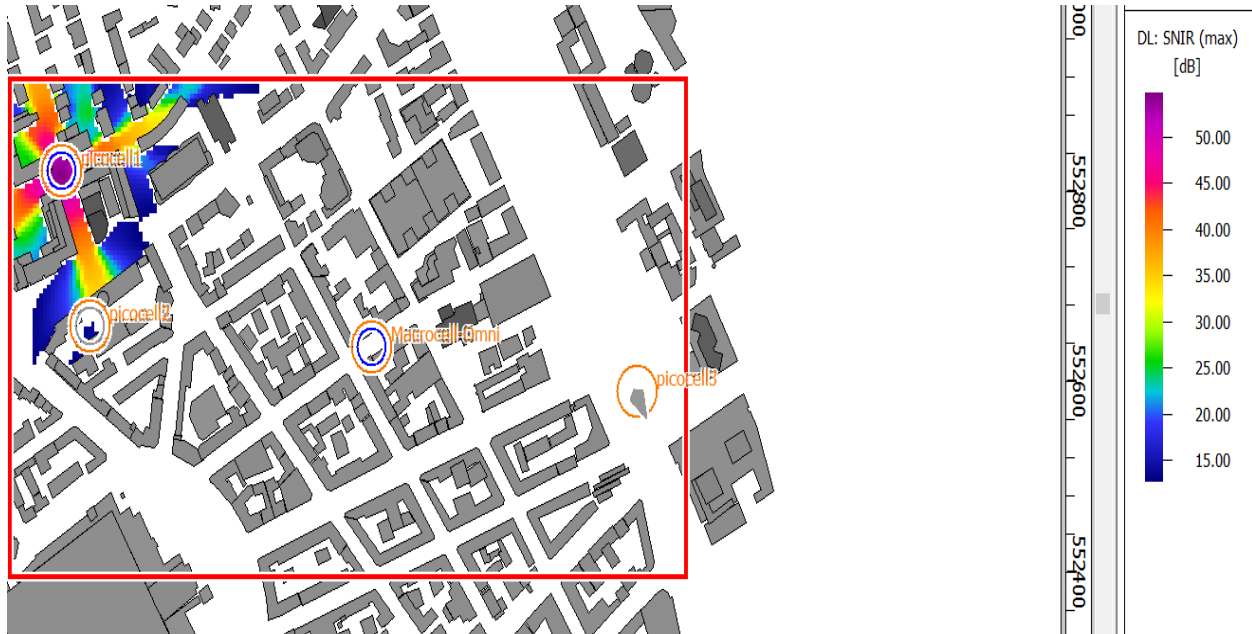
Σχήμα 71: SINR Πικοκυψέλης με συχνότητα λειτουργίας 2650 MHz
