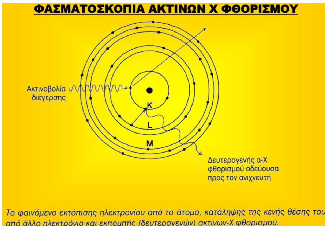
Σχήμα 1.3 Φαινόμενο φασματοσκοπίας ακτίνων Χ φθορισμού
