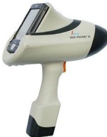
Σχήμα 1.4: Η Συσκευή ΦΑΧΦ που χρησιμοποιήθηκε (τύπος EDX-Pocket III Portable 1.35 Kg XRF Gold Spectrometer, Κίνα), Ακρίβεια 0.001%~0.01%
