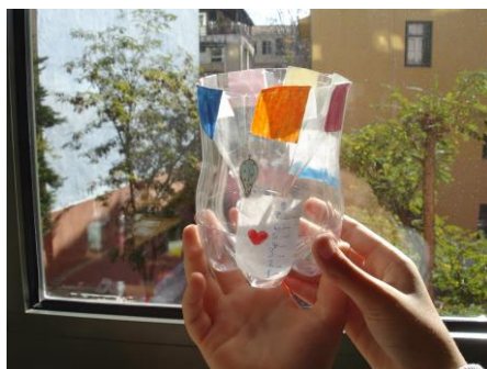
Εικόνα 5.4.3: Αυτοσχέδιο βροχόμετρο με απλά υλικά.
