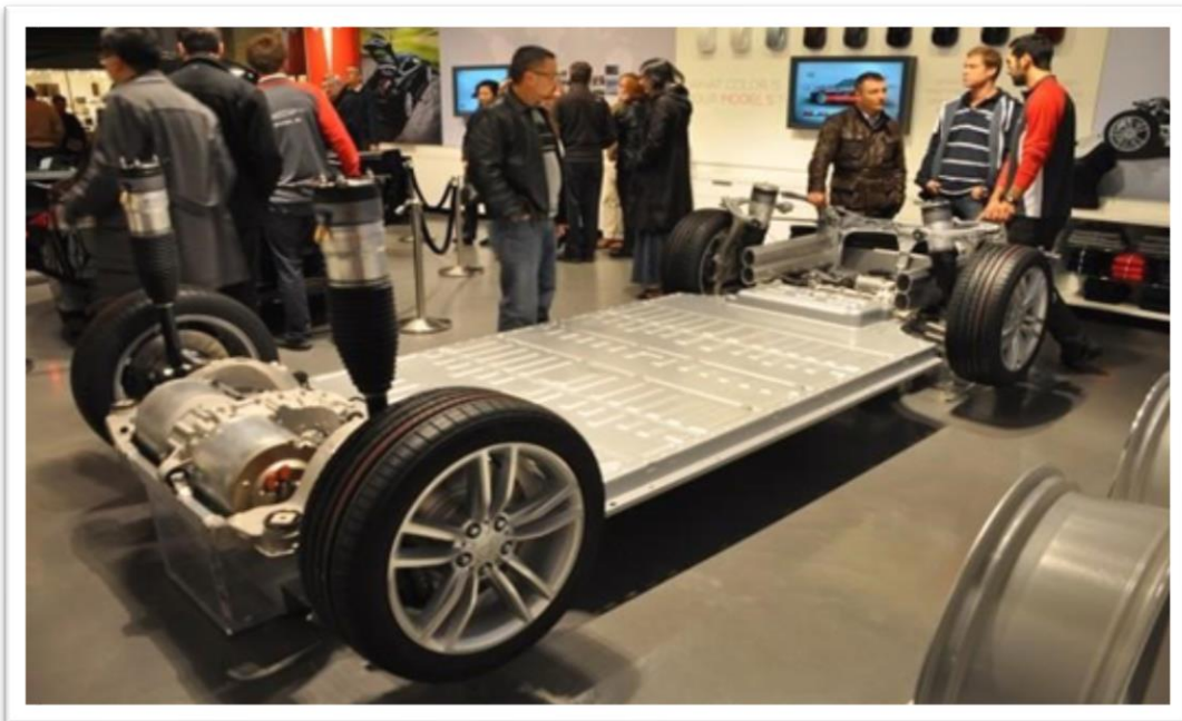
Εικόνα 33 Tesla Model S μπαταρία ιόντων λιθίου (lithium – ion battery)
