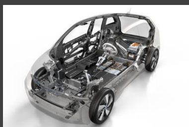
Εικόνα 65 Αμάξωμα από αλουμίνιο BMW i3
