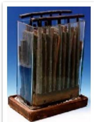
Εικόνα 4 Η μπαταρία μολύβδου - οξέος του Plante
