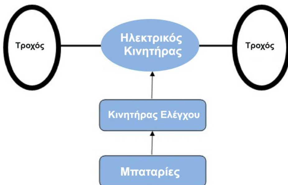
Εικόνα 31 Ο ηλεκτρικός κινητήρας, ο κινητήρας ελέγχου και οι μπαταρίες συσσωρευτές
