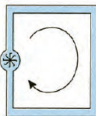
Υδραυλικό ανάλογο ηλεκτρικής πηγής. Εικόνα 2.2-8.
