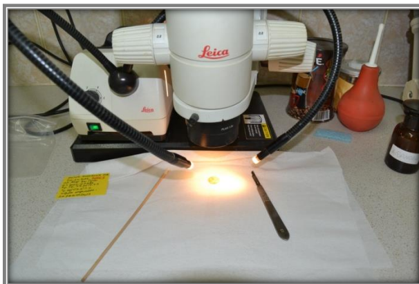
Εικ. 4.1. Οπτικό μικροσκόπιο Leica MZ7S
