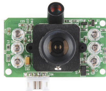
Εικόνα 2.6.6: LinkSprite JPEG Color Camera TTL Interface - Infrared
