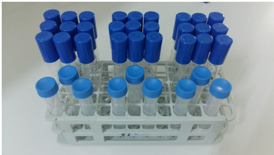
Εικόνα 4.8.1 Πλαστικοί σωλήνες φυγοκέντρωσης με τα τεμάχια AX (μηδενική αραιώση) και γυάλινοι δοκιμαστικοί σωλήνες με 9ml \frac{1}{4} Ringer (δεκαδικές αραιώσεις).
