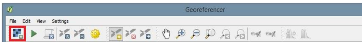
Εικόνα 16: Εισαγωγή του σχεδίου στο “Georeferencer” με την επιλογή “Open Raster”
