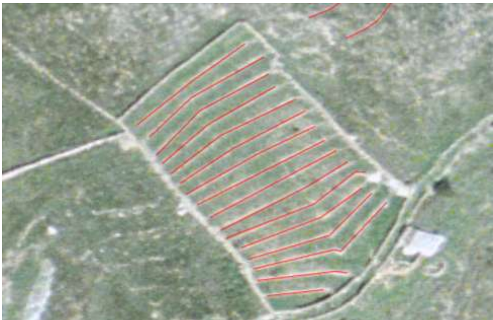
Εικόνα 3β: Τοιχία αναβαθμίδων που χαρακτηρίστηκαν σε καλή κατάσταση, πριν και μετά την ψηφιοποίηση
