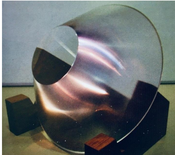
Εικόνα 40: Ενδεικτικό παράθυρο κωνικού σχήματος για το υποβρύχιο Shinkai 6500
