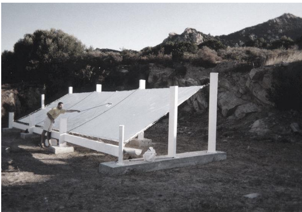
Εικόνα 1.25 - Μεγάλος συμπυκνωτής δρόσου στην Κορσική
