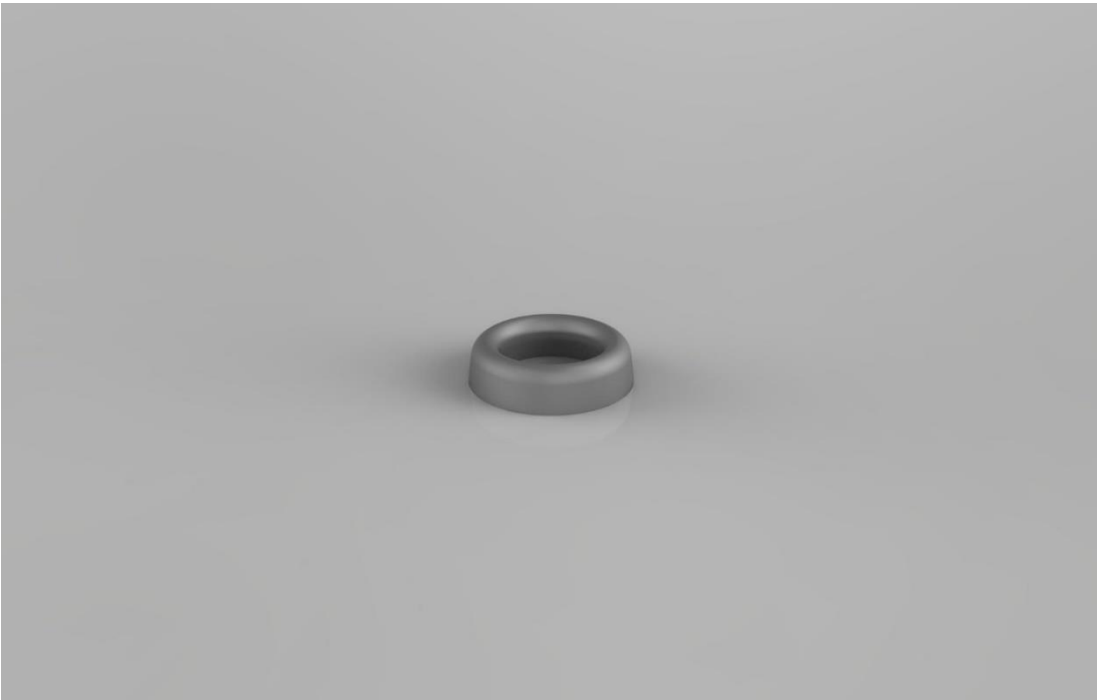
Εικόνα 89 - Τελικό εξάρτημα έπειτα από τη χρήση τόρνου και φρέζας
